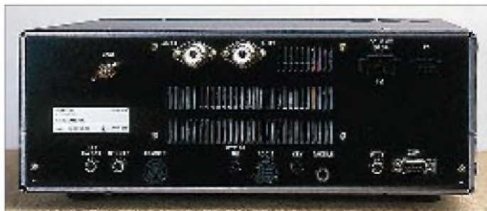
Bild 2: Rückansicht des TS-870S. Zwei Antennenbuchsen erlauben höhere Flexibilität und Schnelligkeit beim Bandwechsel. Die RS.232-Schnittstelle erspart bei PC-Steuerung eine besondere Interfacebox.
