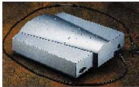
Bild 14: Die elmeg C43 ist eine ISDN-TK-Kompaktanlage für den Small Office-/Home-Markt.
