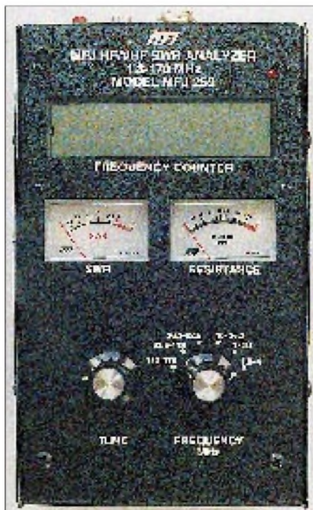
Bild 1: Frontansicht. Oben das LC-Display, darunter die Meßinstrumente für SWR und Widerstand. Links unten die Frequenzeinstellung, rechts der Bereichsschalter. Oben rechts oberhalb des Displays die LED für die Anzeige der Toröffnung. Die SWR-Anzeige hat s = 2 in der Mitte der Skale, oberhalb von s = 3 gibt es keine Skalierung mehr. Die Widerstandsskala zeigt zunehmende Stauchung oberhalb 100 \Omega . Die Instrumente sind nicht beleuchtet, erzeugen jedoch einen Hintergrundbeleuchteten Effekt.
