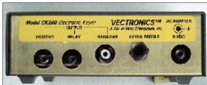
Bild 2: Rückansicht des CK 200. V.l.n.r. die Buchsen für die getrennten Tastenausgänge (negativ: Cinch; Relais: 3,5-mm-Klinke; Stereo; positiv: 3,5-mm-Klinke, Stereo), die Gebegeschwindigkeit (Klinke 6,3 mm, Stereo) sowie die 9-V-Spannungsversorgung (Klinke 3,5 mm, Mono)
