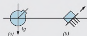
Bild 5: Eine Neigung des Sensors führt zu Meßfehlern, läßt sich aber auch bewußt nutzen.
