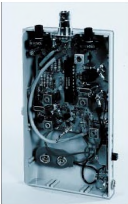
Bild 5: Ansicht des geöffneten Musters des Einkanal-FM-Empfängers
