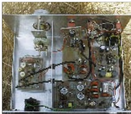
Der betriebsbereite 80-m-Transceiver DTR 3-5 (Lake-Bausatz) von außen und innen
