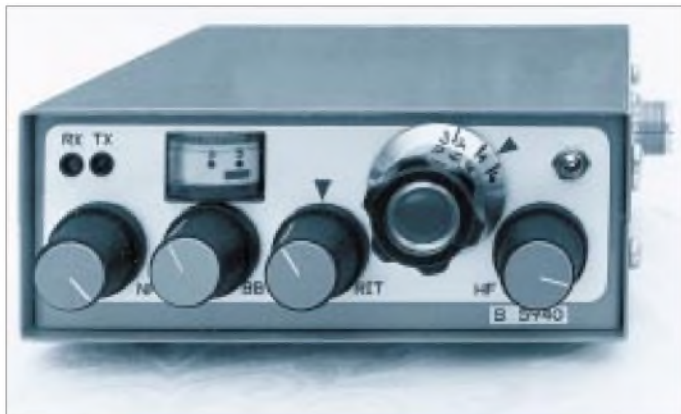
Bild 12: Gesamtansicht des S 5940. Mit dem kleinen Schalter läßt sich die Beleuchtung des Meßinstruments einschalten.
