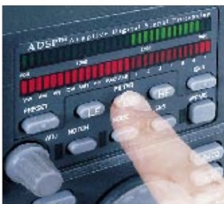
Herzstück des SG-2000 Power Talk™ ist sein DSP-Teil. In der abgebildeten Konstellation wird die Mittenfrequenz eines Bandpasses von 1,1 kHz Bandbreite (1,8 kHz bis 2,9 kHz Durchlaßbereich) verschoben.
