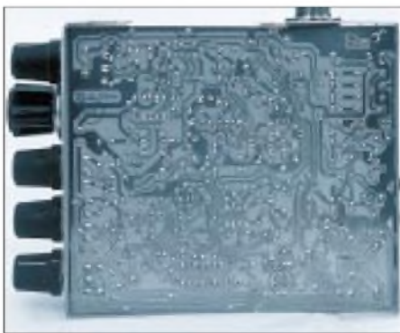
Bild 15: Blick von unten in das geöffnete Gerät. Als Platinengrund- material diente beim Muster Hartpapier.
