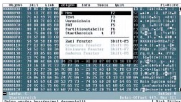
Bild 3: Durch das DOS-Programm UNFORMAT kann man im Notfall den Partition- und Boot-Sektor wieder reparieren. Hilfestellung zur Befehlsyntax erhält man durch den Aufruf von „HELP UNFORMAT“.
