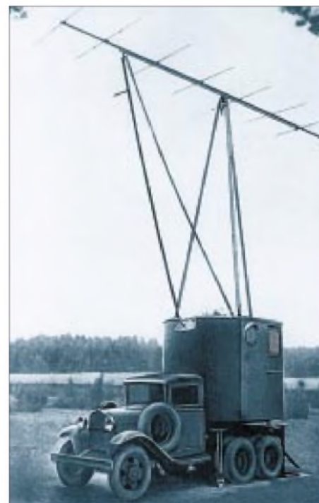
RUS-2: Erste sowjetische Funkmeßstation (Empfangsanlage) 1940
