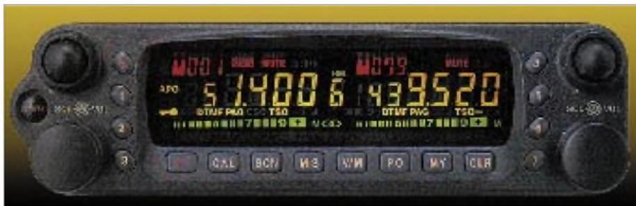
Das mit allen Extras ausgestattete 9600-Baud-fähige FM-Mobilgerät C 5908 B mit abnehmbarem Bedienteil von Standard arbeitet auf 70 cm, 2 m und 6 m.
