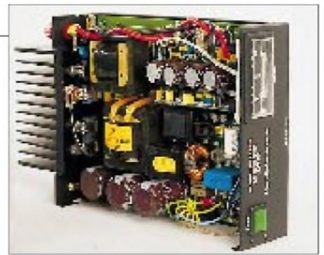
daß Amateurfunk-Transceiver typischerweise ab 11,7 V sicher arbeiten. Tests mit abweichenden Netzfrequenzen waren leider nicht möglich; laut Herstellerangaben verarbeitet es alles zwischen 45 und 440 Hz!
