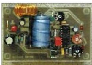
Als Abwärtswandler bezeichnet man sekundärgetaktete Schaltnetzteile, bei denen die Eingangs- in niedrigere Ausgangsspannungen herabgesetzt werden.
