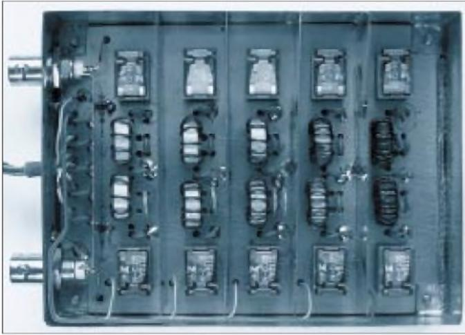
**Bild 9:** Blick in das fertige Filter auf doppelseitig kaschiertem Material und mit eingesetzten Trennwänden. Das fünfadrigre Flachbandkabel verbindet Anschlußfeld und die jeweiligen Relais. Links die BNC-Buchsen für HF-Ein- und Ausgang und das Anschlußfeld mit den provisorisch befestigten Steuerleitungen. Es folgen nach rechts die Filter 24/28 MHz, 18/21 MHz, 10/14 MHz, 7 MHz und 3,5 MHz.
