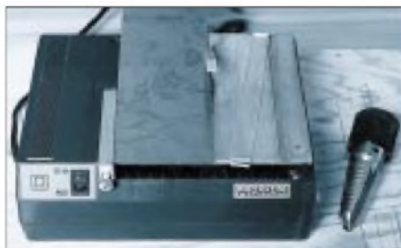
Bild 4: Tischkreissäge mit Hartmetallblatt zum Zusägen von Baisismaterial und Plexiglas/Piacryl. Rechts ein Spezialbohrer zur Herstellung größerer runder Durchbrüche
