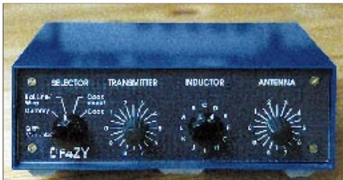
Bild 7: QRP-Matchbox mit 1:6-Balun für abgestimmte Antennen und Abschlußwiderstand
