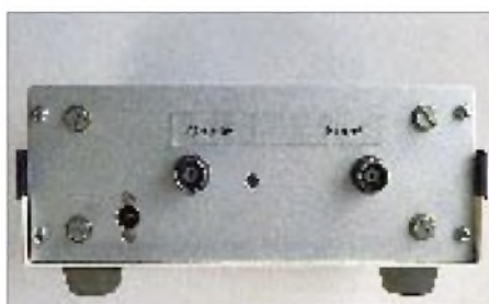
Bild 4: Rückansicht der Meßbrücke mit den Buchsen für das Meßobjekt und den Empfänger
