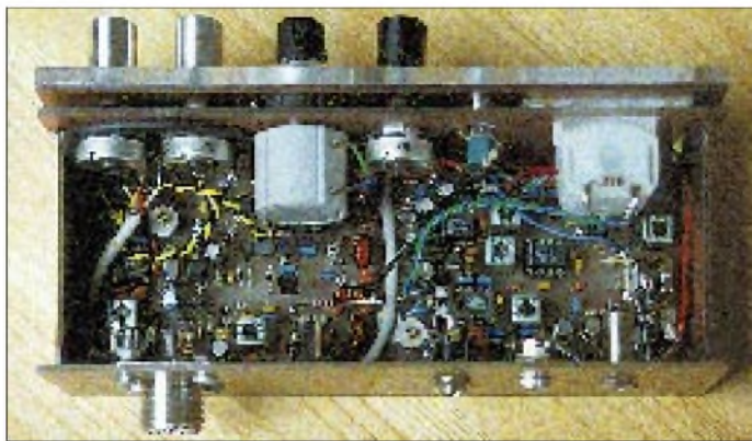
Bild 6: Betriebsbereiter CW-Transceiver für das 40-m-Band mit 2 W Ausgangs- leistung an 50 Ω
