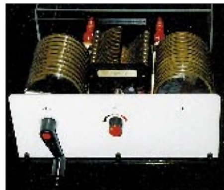
Der vollsymmetrische Hochleistungskoppler von DL3KCH ist als symmetrisches Pi-Filter mit bewegten Rollspulen ausgeführt
