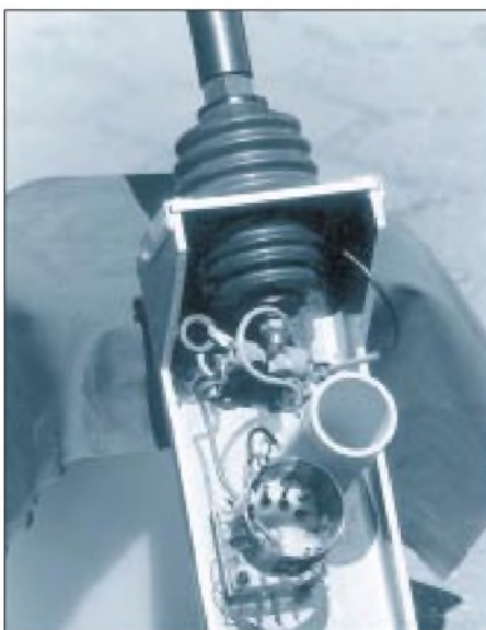
Bild 2: 80-m-Anpaßbox für eine 4,5 m lange Stabantenne. Links oben innerhalb der Halterung die keramischen Rohrcondensatoren (3 Stck., insgesamt 1600 pF, darunter die angezapfte 5-µH-Luftspule, rechts davon die 40-µH-Spule mit aufgebrannter Wicklung.
