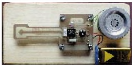
Der Morseübungssummer AS 01, der von Wolfgang Lipps, DL4OAD, und Günther Borchert, DF5FC, entwickelt wurde. Der Bausatz kann über den AATiS e.V. bezogen werden.
