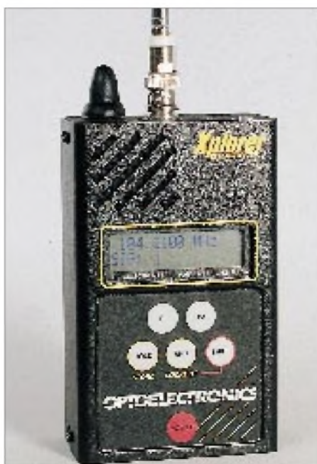
Der Xplorer ist ein Frequenzzähler mit scanner- bzw. empfängerähnlichen Eigenschaften.
