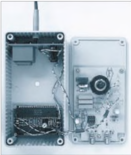
Bild 8: Blick in das geöffnete Gerät. Links im Bild die Meßplatine, rechts unten das Netzteil und oben das Panelmeter.
