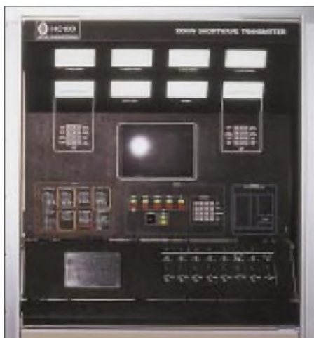
Die Ingenieure von Radio HCJB haben die eingesetzten Kurzwellensender zum Teil selbst entwickelt. Hier einer der 100-kW-Sender mit der Typenbezeichnung HC 100.
