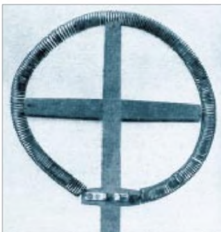
Resonator mit spiralförmig aufgewundenem Draht für lange Wellen.
