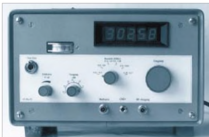
Bild 1: Frontansicht; oben die Anzeige in kHz, links daneben der Indikator, unten die Buchsen für HF-Ausgang und Meßverstärker, dazwischen die Massebuchse. In der Mitte v.l.n.r.: Netzschalter, Steller für die Verstärkung des Meßverstärkers, Pegelsteller, Bereichsumschalter, Frequenzeinstellung
