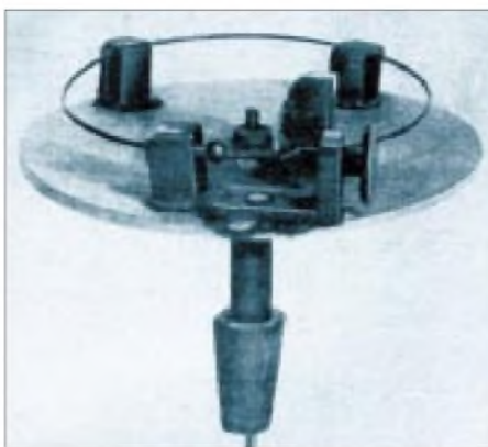
Kleinsten von Hertz hergestellter Resonator: Ein Kupfering mit einstellbarer Funkenstrecke ist mittels Siegellack auf einem Zigarrenholzbrettchen befestigt.
