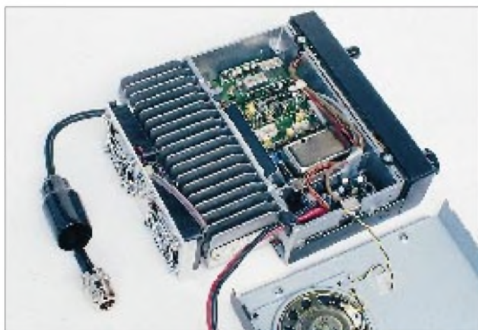
Denpas neues MZ-45 zeigt in der Innenansicht solide Betriebsfunkqualität mit relativ großen Vor- und Zwischenkreisen für vernünftige Empfangsleistungen.
