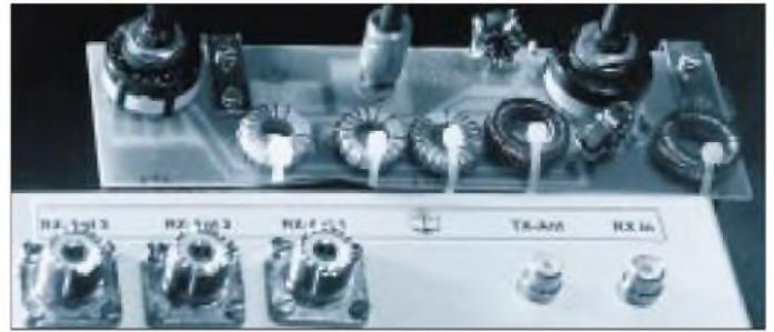
Bild 4: Der BCC-Preselektor mit herausgeklappter Leiterplatte
