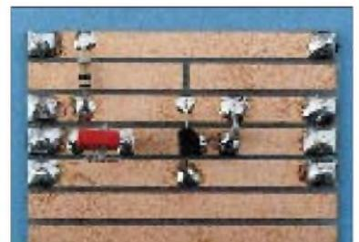
Der NF-Verstärker, aufgebaut auf einer Streifenleiterplatte
