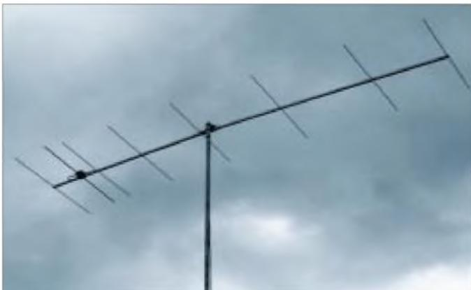
Bild 20: Die 8-Element-Yagi mit gestrecktem Dipol
