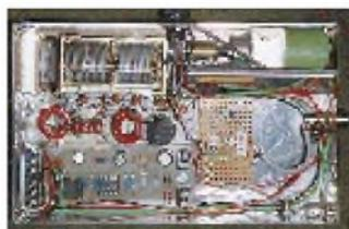
Der Versuchsaufbau der Aktivantenne beinhaltet einen abgesetzten Antennenkopf und die Elektronik zur Fernabstimmung.
