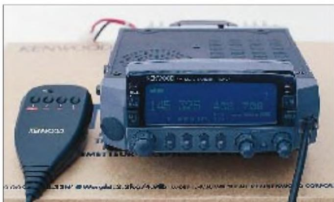
Das Bedienteil des TM-V7E läßt sich bequem per rückseitiger Schiebeschalter-Raste entfernen. Die Verbindung zum Transceiver beschränkt sich wie beim TM-733E auf nur vier Kontakte.
