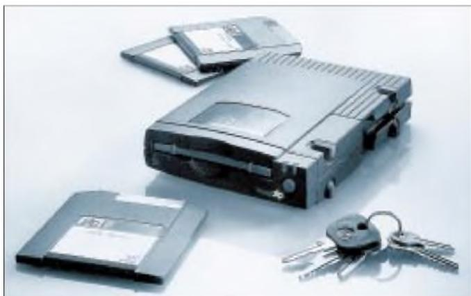
**Bild 1:** Das Zip-Laufwerk zeichnet sich durch eine einfach zu handhabende 100-Megabyte-Speicherlösung aus.
