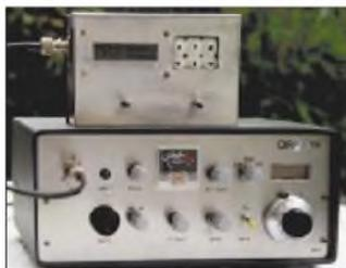
Beim Autor diente der DDS-Generator in der Hauptsache dazu, den instabilen VFO eines QRP-Portabel-Transceivers zu ersetzen. *Foto: DL9FCR*
