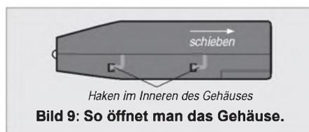
**Bild 9:** So öffnet man das Gehäuse.
