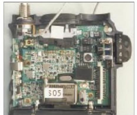
Winzig klein ist die Leiterplatte des Signalteils des C510E. Gerade noch erkennbar die drei ZF-Filter, der VCO und ein Quarz. Ein EEPROM (rechts von der CPU) hält die 200 Speicherinhalte auch ohne Speicherschutz-batterie.
