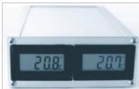
Die Temperaturmodule können zweckentsprechend in ein passendes Alu-Gehäuse eingebaut werden.
