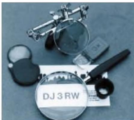
Bild 1: Übliche Sehhilfen für SMD- und IS-Lötarbeiten
