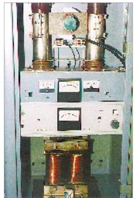
Blick in die mit zwei sowjetischen Röhren GI 7 B bestückte 2-m-Endstufe von DL1DUR
