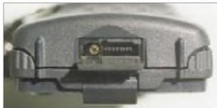
Eine Gummikappe schützt die Multifunktionsbuchse auf der Unterseite des Handfunkgeräts. Wird hier der Booster angeschlossen, schaltet sich die Antennenbuchse auf der Geräteoberseite automatisch ab. Zugleich übernimmt der Booster die Stromversorgung.
