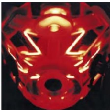
Micro-Lasergyro mit 12 cm Strahllänge
