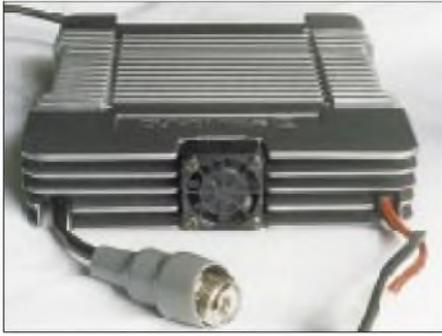
**Für die Kühlung der Endstufe des Boosters sorgt außer dem massiven Gehäuse ein winziger Lüfter; die PL-Buchse ist abgesetzt.**
