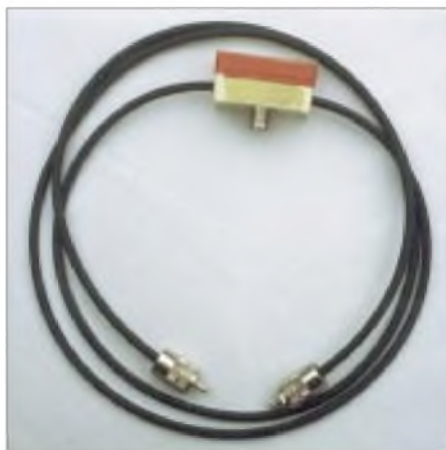
Bild 16: Fertiges Aufstockkabel für den Portabeinsatz
