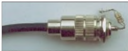
Bild 15: Selbstgebauter Abschlußwiderstand 50 Ω zum Messen der Anpassung
