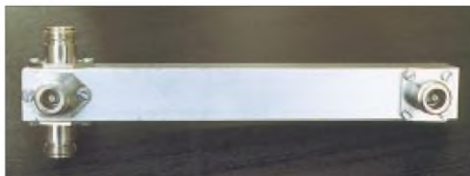
Bild 8: Selbstgebaute Vierfachverteiler für das 70-cm-Band
