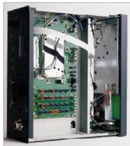
Der Blick in den geöffneten Empfänger zeigt, daß hier noch viel Platz für Erweiterungen ist. Oben auf dem Montageblech befindet sich die HF-Leiterplatte, darunter (nicht sichtbar) die ZF/NF-Leiterplatte. Unten im Bild die Spulen der Eingangsfilter; rechts die hinter der Frontplatte angeordnete Prozessoreinheit
