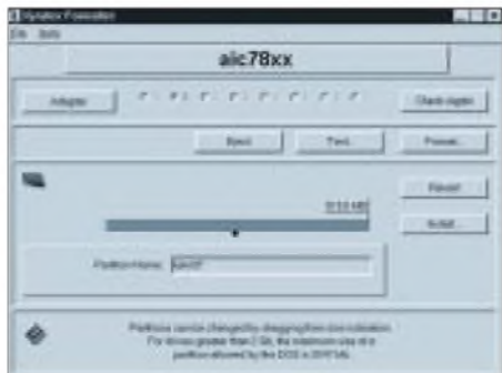
Der „Xyratex Formatter“ führt gegebenenfalls eine Low-Level-Formatierung durch und partitioniert den Datenträger.
