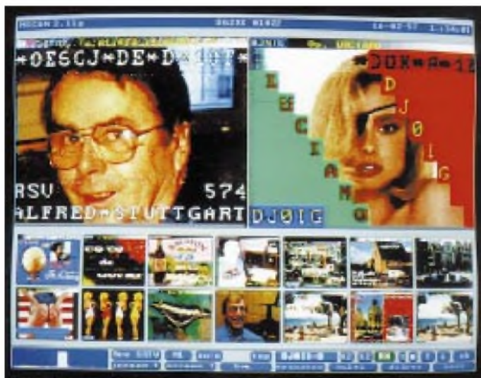
Bild 1: Der Hauptbildschirm von Multiscan 2.11 mit zwei Bildfenstern, 14 Thumbnails, der Spektrumanzeige (unten links) sowie einer Indikator- und einer Menüleiste für die Mausbedienung.
