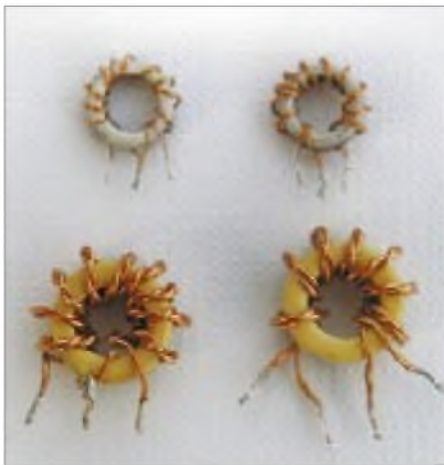
Bild 4: Ansicht der fertig bewickelten Kerne für die Endstufe
