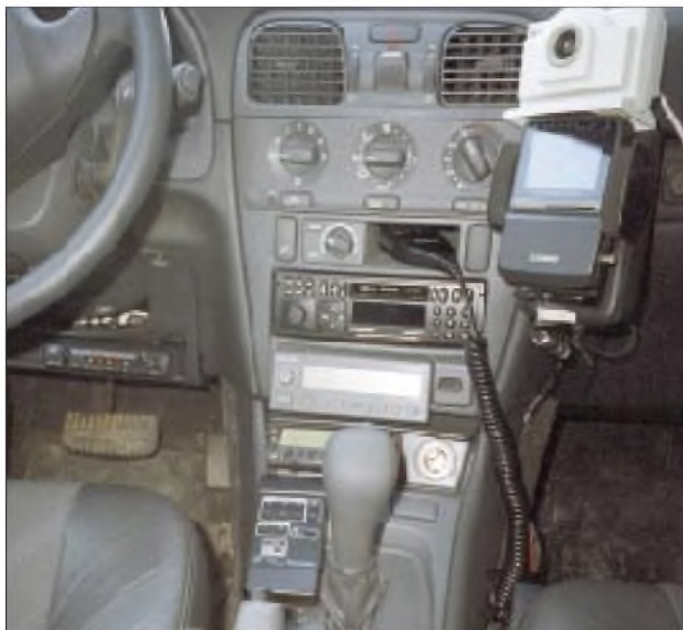
Bild 4: SSTV-Mobil auf 2 m und 70 cm ist, wie man sieht, kein Problem. In der Ablage der TSC-70P. Neben dem Schalt- hebel liegt die Fern- bedienung. Neben der Konsole oben rechts die Handy-Halterung mit dem LCD-Fernseh- empfänger als SSTV-Monitor und Kontrollmöglichkeit für das eigene Kamerabild, darüber im weißen Gehäuse die CCD-Farbkamera.
