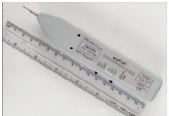
Bild 2: Rückseite des osziFOX. Auf dem beschrifteten Feld sind die Schalt- stellungen des Ein- gangswahlschalters sowie des Eingangs- spannungsteilers markiert. Links oben vom Beschriftungs- feld eine kleine Buchse für GND, darunter die Buchse für die externe Triggerung. Fotos: DL7UMO
