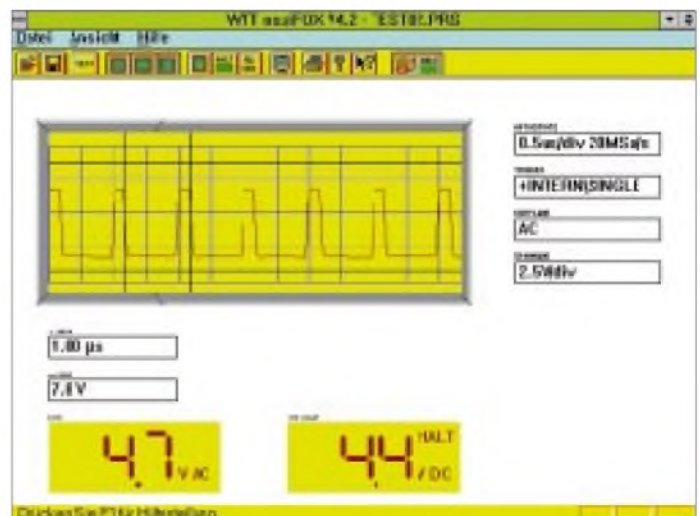
Bild 7: Spannungsverlauf am 1-MHz-Ausgang eines Teilers. Die vier Fenster oben rechts geben Auskunft über die Einstellung des osziFOX, die beiden unteren links zeigen die Zeitdifferenz (umschaltbar auf Frequenz) und darunter die Spannungsdifferenz der insgesamt vier hier nachträglich gesetzten Cursoren.
