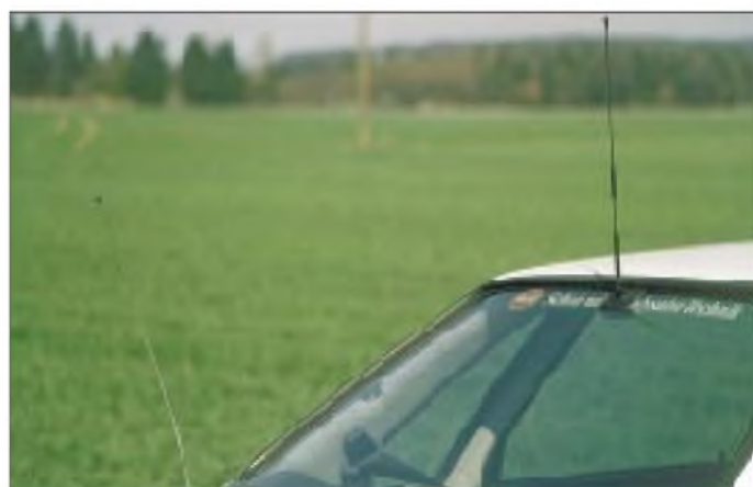
DAB-Onglass-Antenne für Band III und L-Band von Kathrein mit Gegengewicht im Wageninneren plus reguläre Autoradioantenne Fotos: W.-D. Roth
