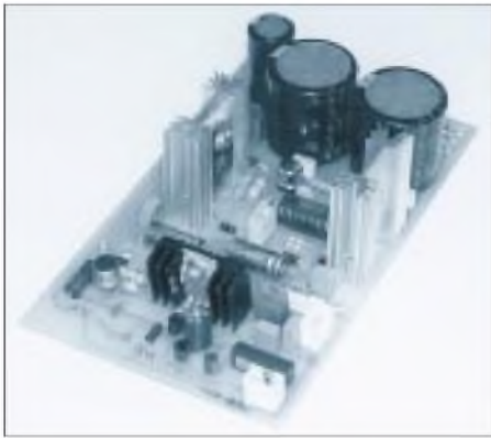
Bild 6: Das Netzteil wurde mit diskreten Bauelementen realisiert.
