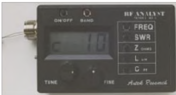
Bild 5: Das RF-1 von Autek/stabo bei der Messung einer Kapazität von 10 pF Fotos: DL7UMO
