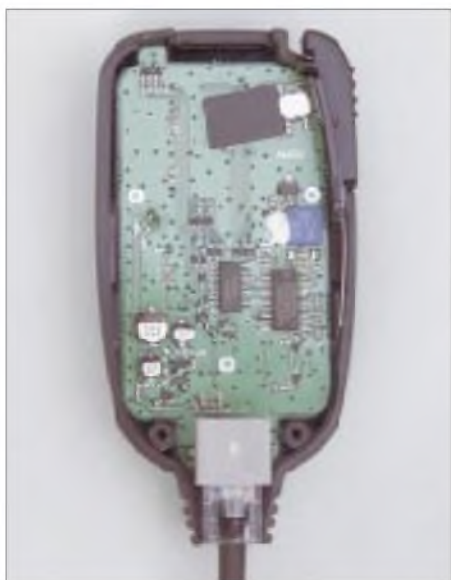
Im zum Lieferumfang gehörenden Mikrofon verbirgt sich schon ein halber Computer, der alle Steuerungsvorgänge ermöglicht.
