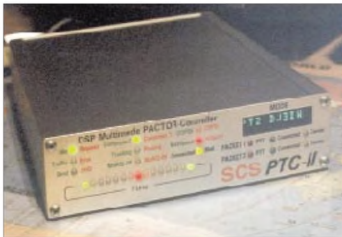
Bild 9: Anzeige im Betrieb; oben Status, links unten die Feinabstimmung, rechts Sendart und Rufzeichen Fotos: DL2DUL
