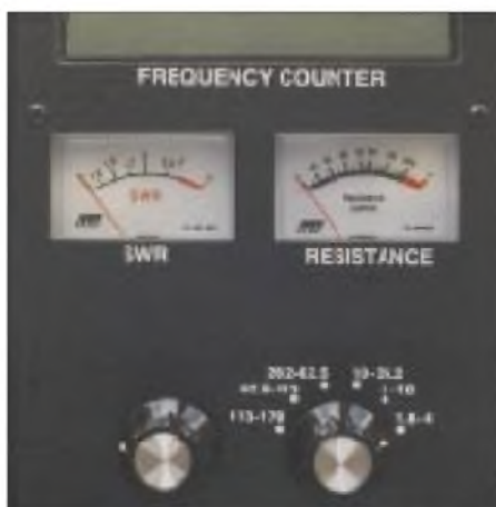
Bild 4: MFJ-259-Teilansicht mit Frequenzeinstellung, Bereichsschalter, Anzeigeinstrumenten und Display
