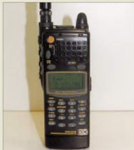
Aincos DJ-X10 ist ein Breitband-Scanner für 100 kHz bis 2000 MHz mit 1200 Speicherplätzen, dessen Channel Scope bis zu 40 Kanäle gleichzeitig überwacht und im Display darstellt.
