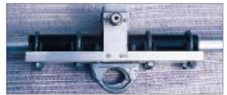
Bild 4: Das isoliert gehaltene Strahlerrmittelstück
