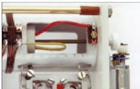
Bild 4: Wie Bild 2, Schlitten am rechten Endanschlag. Die beiden Litzen für den Schlitten benötigen viel Freiraum. Fotos: DL7UMO
