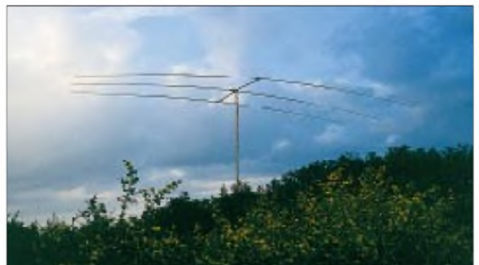
Bild 7: Die für 20 m eingestellte Yagi im Gestrüpp der Macchia auf Sardinien. Höhe über Grund 10 m Fotos: DK7ZB
