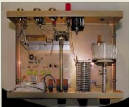
Ein interessantes Detail des Antennentuners VC 300 DLP von Vectronics ist die Induktivität nach dem Prinzip des Ringkern-Stelltransformators.
