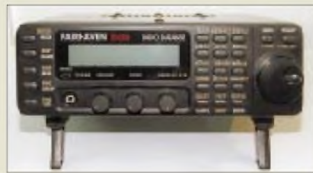
Der ebenfalls computersteuerbare Fairhaven RD 500 empfängt von 40 kHz bis 40 MHz und kann mit stattlichen max. 57 000 Speicherplätzen on board aufwarten.
