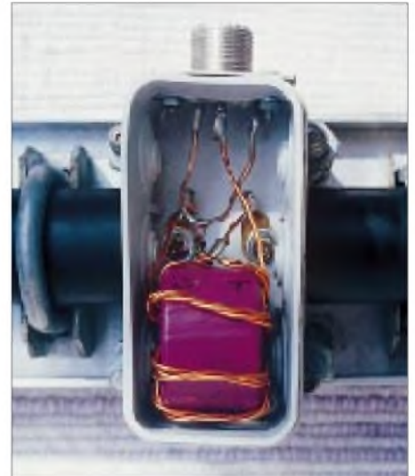
Bild 5: Anschlußdose mit Balun und Koaxialbuchse
