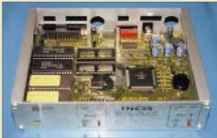
Der TNC 3S von Symek verfügt über eine SLIP-Schnittstelle, die Packet-Radio im Internet-Look erlaubt.
