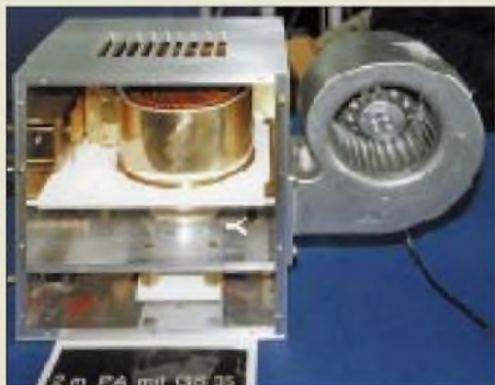
Für besondere Wünsche findet sich oft ein Hersteller, der etwas in Einzelfertigung produziert. Hier eine 1,5-kW-Endstufe für 2 m mit der GS 35 von Hubert Tiedmann, DJ3FI
