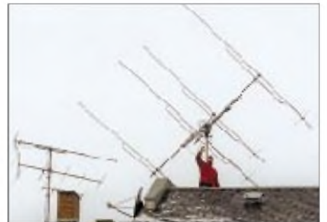
Die vier 11-Element-DL6WU-Langyagis, mit denen Jürgen, DL1DUR aus JO70KV, MS und EME macht Foto: DL1DUR
