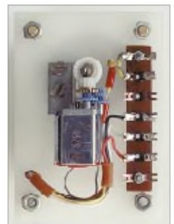
Bild 2: Die komplette Baugruppe mit Schlitten fast am linken Endanschlag, rechts unten die Platte mit den Mikrotastern zur Endabschaltung, daneben die beiden Leistungsrelais, auf der rechten Seitenplatte der Motor mit Getriebe.
