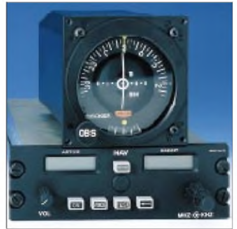
VOR-Empfänger mit zugehörigem Auswertegerät der Firma Becker Flugfunkwerke Foto: Becker
