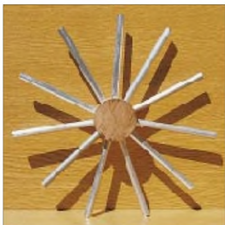
Bild 4: Mittelstück („Spinne“) zum Herstellen der Wabenspulen
