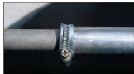
Bild 2: Rohrarrretierung mit Hilfe von Schlauchschellen und Schlitten
