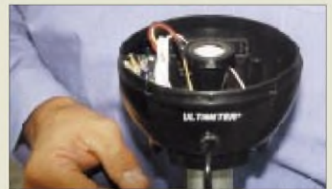
Der neue Regensensor der von der Fa. Hummel vertriebenen Davis-Wetterstation mißt unmittelbar die durchtretende Wassermenge. Fotos: Werkfotos, TO
