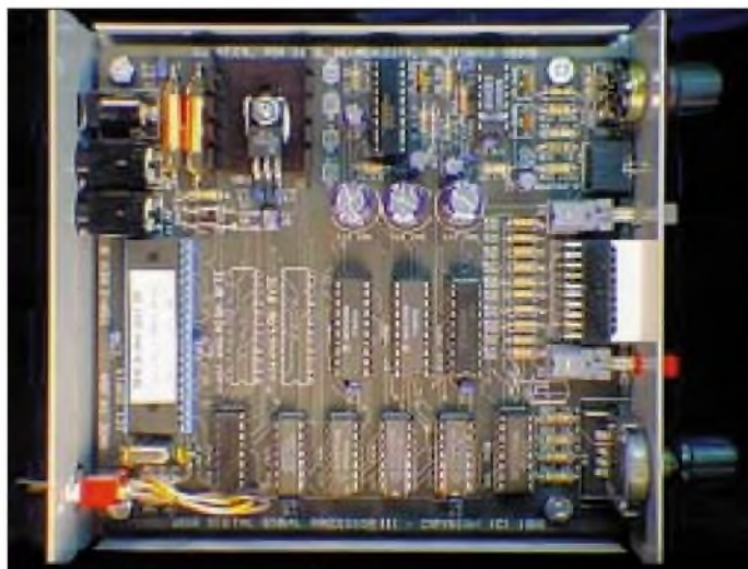
Bild 7: Innenansicht des W9GR DSP III
