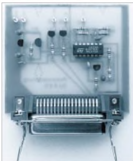
Bild 4: Ansicht der Platine für die Antennen- fernsteuerung
