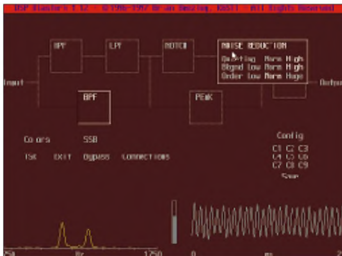
Bild 5: Telegrafiesignal mit aktiviertem Bandpaß- und Peak-Filter (800 Hz)
