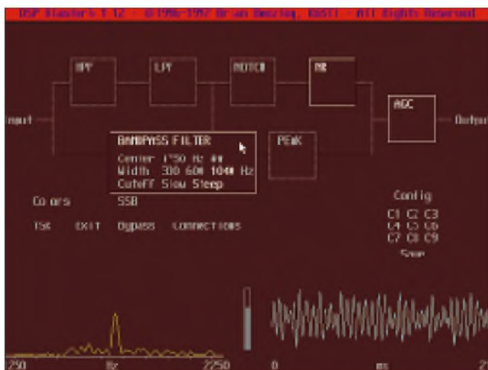
Bild 3: SSTV-Signal. Die Mittenfrequenz des Bandpaßfilters wurde auf 1750 Hz eingestellt. NR und AGC sind aktiviert.
