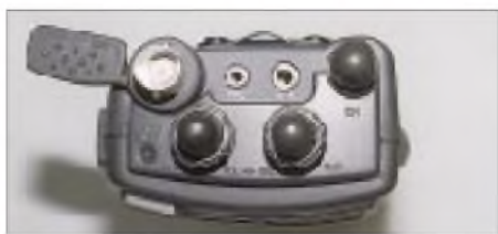
Ansicht von oben: BNC- und abdeckbare Klin- kenbuchsen, Hauptabstimmknopf und koaxial angeordnete Drehsteller für Lautstärke und Rauschsperr plus „S/E-Leuchtdiode“ prägen das Bild.
