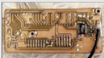
Das Schwierigste bei diesem DDS-VFO ist das Einlöten des AD 9850 mit seinem 0,65-mm-Pinraster und einigen SMD-Bauelementen. Foto: DL4JAL
