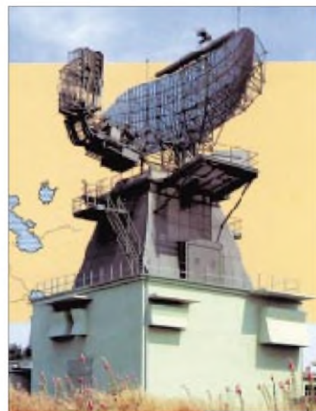
Thomson-CSF Ares 3D-Radar – ursprünglicher Bestandteil des NADGE
