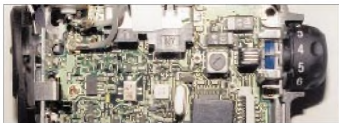
SMD-Technik in Vollendung: Die Bauteile im Gerät lassen sich teilweise nur noch mit einer Lupe erkennen.
