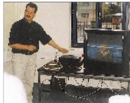
Störung durch zu enge Nachbarschaft eines schnurlosen DECT-Telefons und eines SAT-Receiver Foto: BAPT
