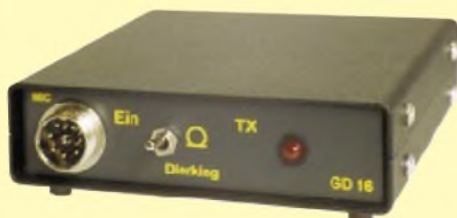
Bild 3: Der in ein Gehäuse eingebaute Sequencer GD 70 heißt GD16.
