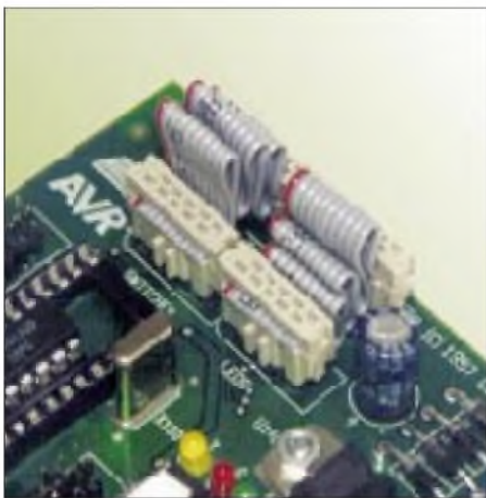
Bild 2: Flachbandleitungen verbinden die I/O-Leitungen.
