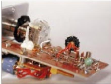
**Bild 8: Detailansicht des KW-Bausteins mit HF-Transformator**
