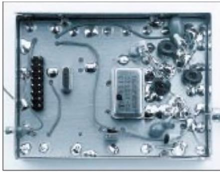
**Bild 18:** Auf der „Bestückungsseite“ wurden noch einige Bauelemente, insbesondere der ausgangsseitige Tiefpaß, frei verdrahtet.
