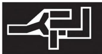
**Bild 3: Trennlinien-Leitungsführung der Platine für die HF-Meßbrücke**
