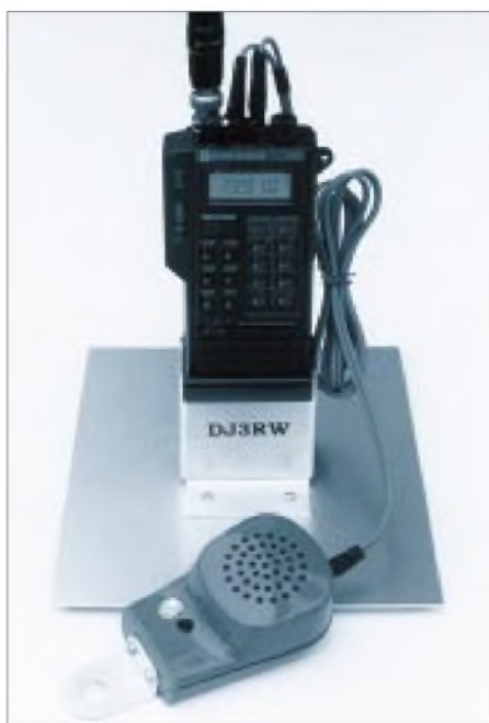
Bild 3: Handy als Feststation mit Telefonhörkapsel als Lautsprecher-Mikrofon
