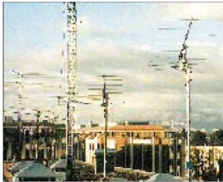
4U1ITU-DXpedition: Vom 11. bis 15.12. aktivierten Wolfgang, DF8AA, und Steffen, DD0VF, die UN-Station in Genf auf 2 und 6 m. Im Meteorscatterbetrieb gelangen 25 QSOs. Im Bild die neuerrichteten Antennen für den 2-m-Betrieb (8- und 9-Ele.-Yagi).
