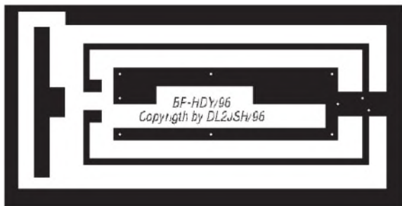
Bild 10: Layoutvorschlag einer Platine für eine Bandsperre. Die Rückseite der 1,5 mm dicken doppeltkaschierten Platte bleibt voll als Kupferfläche stehen.
