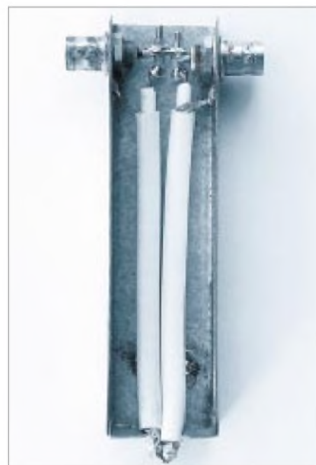
Bild 14: Saugkreisfilter aus Koaxialkabel realisiert Fotos: DL2JSH
