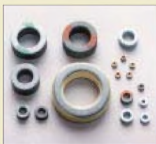
In der Bastelkiste schlummern oft noch Ringkerne, die wegen unbekannter Daten keine Verwendung finden können. Mit Hilfe eines SWR-Analysators kann man sie ausmessen.
