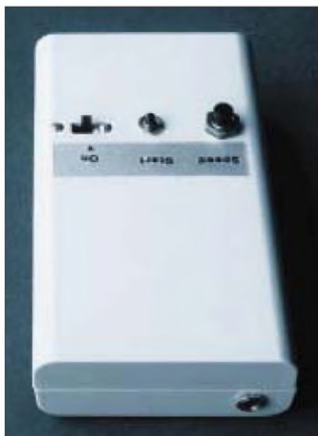
Bild 5: Blick auf das geschlossene Gerät. In der Stirnseite die Klinkenbuchse für die Sendertastung, oben der Achsstummel des Minipotentiometers, darüber die Starttaste und der Schiebeschalter.
