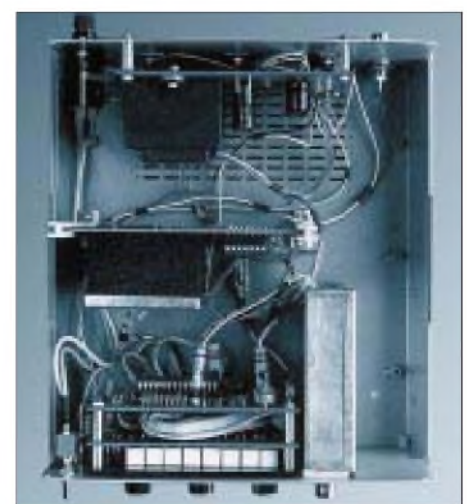
Bild 20: Blick von oben. Vorn die Einheit Acrylscheibe – Display – Zähler. In der Mitte die Steuerung mit Thermostathäube. An der Rückseite die Stromversorgung.
