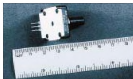
Bild 2: Die mechanischen Abmessungen des Encoders betragen nur wenige Quadratzentimeter. Foto: Autor
