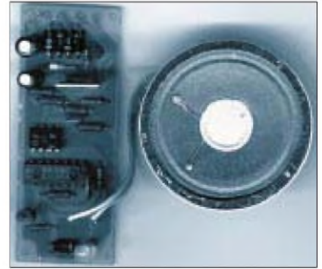
Bild 4: Ansicht des Durchgangsprüfers (hier mit einem Lautsprecher als Signalgeber)
