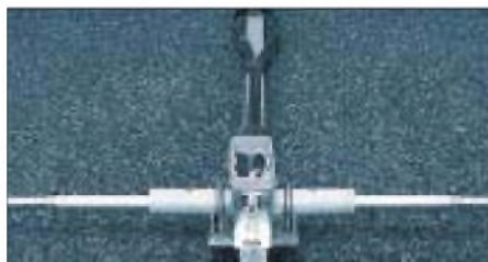
Bild 2: Das isoliert gehaltene Mittelstück des Strahlers
