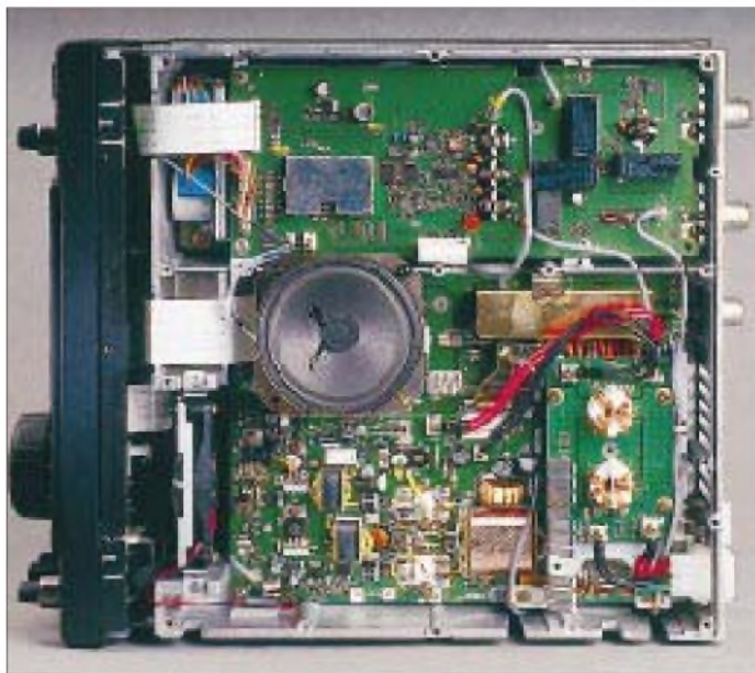
Ansicht von oben in den geöffneten IC-746. Das stabile zwangsgekühlte Druckgußgehäuse kommt auch beim Dauersenden ohne Kühlrippen aus.
