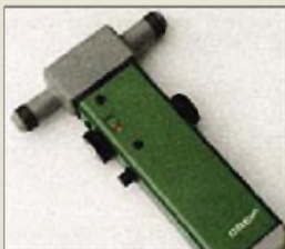
Ein elektromechanischer Antrieb stimmt die Mobilantenne ab.
