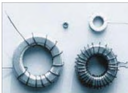
Bild 4: Zur Bestimmung des nutzbaren Frequenzbereichs mit Testwindungen versehene Ferritringkerne
