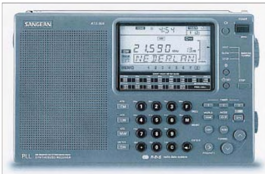
Der Sangean ATS 909 verfügt neben einer Tastatureingabemöglichkeit für die Frequenz zusätzlich über einen Abstimmknopf, mit dem man beispielsweise SSB-Stationen im oberen oder unteren Seitenband in 40-Hz-Schritten einstellen kann.
