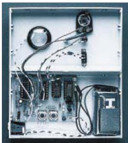
Bild 6: Das Innere des Geräts. Die Leiterplatte wurde aus Platzgründen asymmetrisch angeordnet. Unten auf ihr sind die beiden Programmier Tasten zu erkennen, im Oberteil die eingeklebte Piezoscheibe. Fotos: DL7UMO
