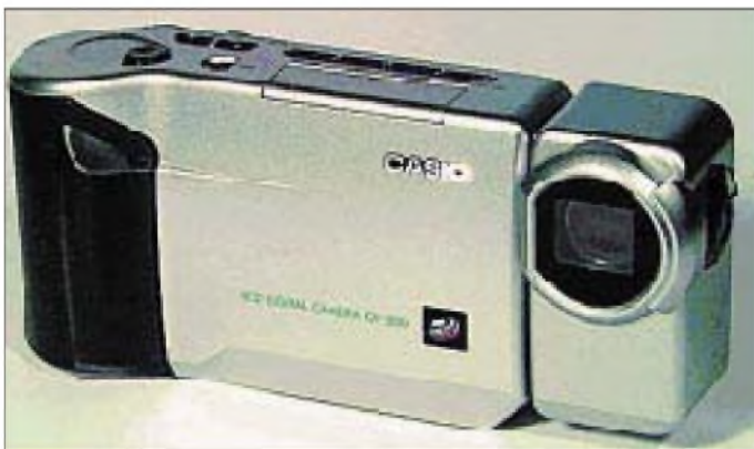
Bild 1: Die QV-300 von CASIO ist nachtblind. Aufgrund des fehlenden Blitzes eignet sie sich nur für helle Umgebungen.
