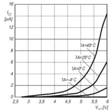
**Bild 10: Power-Down-Betriebsstrom bei passivem Watchdog-Timer bezüglich verschiedener Umgebungstemperaturen**
