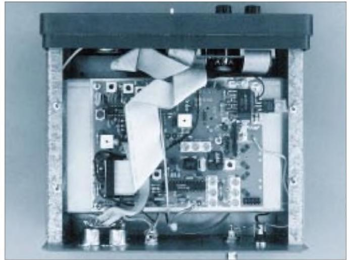
Besonders die stets notwendige Anpassung bereitete Probleme. Die maximal erlaubte Betriebsspannung liegt bei 10 V. Die Betriebsspannung wird daher mit einem 78 S 075 auf 7,5 V gebracht. Er sitzt mit auf dem Kühlkörper der Endstufe. Die Spannung muß nicht geschaltet werden. Für die S/E-Umschaltung dient die Vorspannung, die hier einen eigenen Regler und Schalter besitzt.
