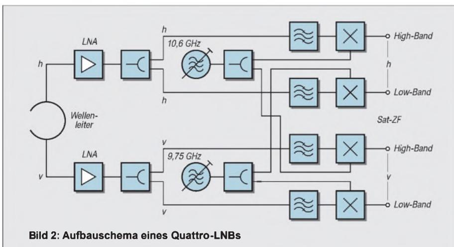
Bild 2: Aufbauschema eines Quattro-LNBs
