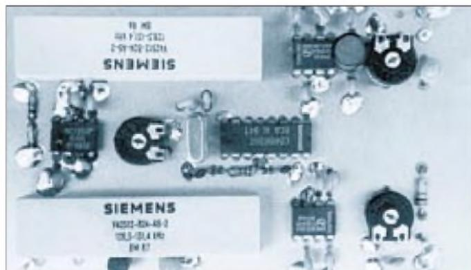
**Bild 4:** Foto des HF-Clippers als Aufbau mit bedrahteten Bauteilen. Die großen Siemens-Bauteile sind die Resonatorfilter
