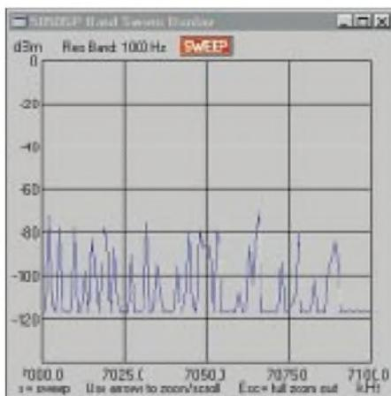
**Bild 11: Der Kachina kann in einem eigenen Fenster das Spektrum eines Bandabschnitts von 25 kHz bis 500 kHz Breite darstellen. Klickt man mit der Maus auf einen Punkt im Spektrum, ist man gleich auf der zugehörigen Frequenz.**
