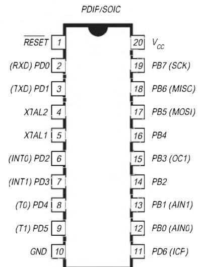
Bild 2: Anschlußbelegung
