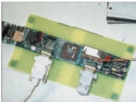
**Blick ins Phase 3-D-RUDAK-Hardware-Entwicklungslabor: Der Smart-Node-Board – hier laufen verschiedene analoge Telemetriedaten auf den CAN-Bus. An der linken Seite des Boards befindet sich eine RS-232-Steckverbindung. Das andere Kabel gehört zum CAN-Bus. Die beiden Kabel rechts dienen der Gleichspannungsversorgung des Moduls im Laboraufbau. Die etwas mysteriös aussehenden Objekte in der rechten oberen Ecke sind simple 3,5-Zoll-Disketten.**
