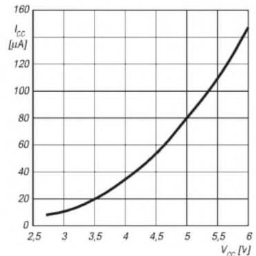
**Bild 9: Power-Down-Betriebsstrom bei aktivem Watchdog-Timer ( $T_A = 25\text{ °C}$ )**
