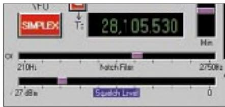
**Bild 10: Die Funktionen der unteren Schieberegler werden dem jeweiligen Zweck angepasst. Hier dienen sie der Einstellung von Notchfrequenz und Rauschsperrschwellen.**
