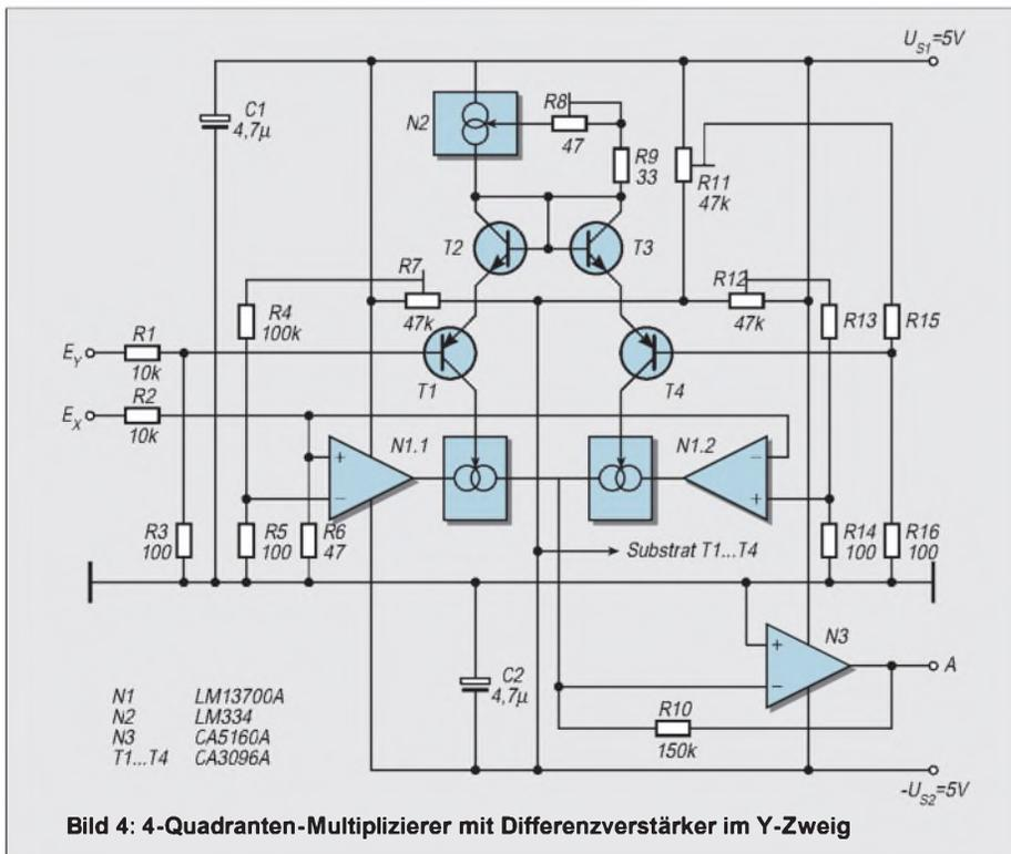
grierten Stromquelle N2 einen Differenzverstärker, der aus der Eingangsspannung  $U_Y$  die Stromdifferenz  $I_{STN1.1} - I_{STN1.2}$  ableitet.
