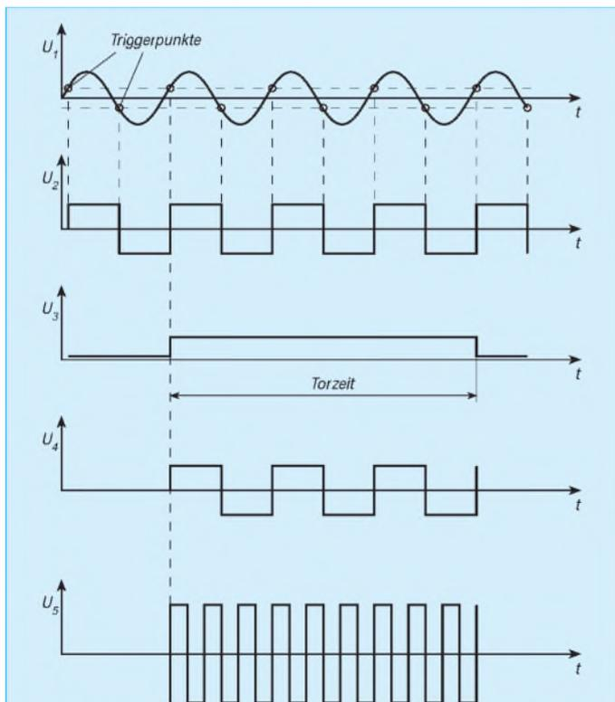
**Bild 3:** Bei der konventionellen Meßmethode sind Eingangs- und Torzeitsignal nicht synchronisiert. Im Eingangsteil entsteht aus der Signalspannung  $u_1$  mit dem Schmitt-Trigger eine frequenzgleiche Rechteckspannung  $u_2$ , deren Perioden während der Torzeit  $u_3$  gezählt und mit dem Meßtaktsignal  $u_4$  für die Frequenzmessung ausgewertet werden.
