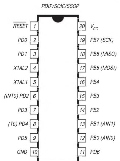
Bild 2: Anschlußbelegung
