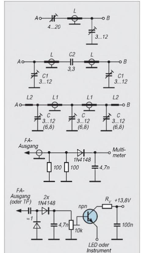
**Bild 4:** Tiefpaßfilter 1 als L-Glied. L: 50-Ω-Koaxialkabel der Länge  $v \cdot 0,8 \cdot \lambda/4$ ; A: Eingang  $\geq 50 \Omega$ ; B: Ausgang  $\leq 50 \Omega$ . Bei Verwendung keramischer Scheibentrimmer von 10 mm Durchmesser ist dieses Filter bis über 20 W einsetzbar. Es ist mit einer Dämpfung der ersten Oberwelle von etwa 18 dB zu rechnen.
