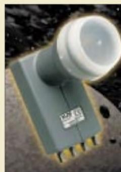
Quattro-LNBs wie dieses der Fa. ALPS sind die universellsten. Sie empfangen den gesamten Frequenzbereich 10,7 bis 12,75 GHz und stellen ihn getrennt nach den beiden Bändern und Polarisationen an vier Ausgängen zur Verfügung.
