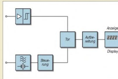
Die Grundschialtung eines Universalzählers besteht in einer Eingangsschaltung mit Schalttrigger, der Zeitbasis mit daran anschließendem Steuerblock (Impulsformer, Vervielfacher bzw. Teiler), einer Torschaltung und dem Anzeigeteil.
