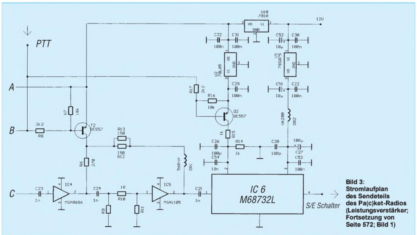
**Bild 3:** Stromlaufplan des Sendeteils des Pa(c)ket-Radios (Leistungsverstärker; Fortsetzung von Seite 572; Bild 1)
