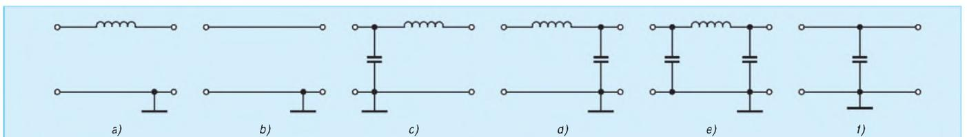
**Bild 4: Konfigurationsmöglichkeiten des Anpassungsnetzwerks des SG-230**
