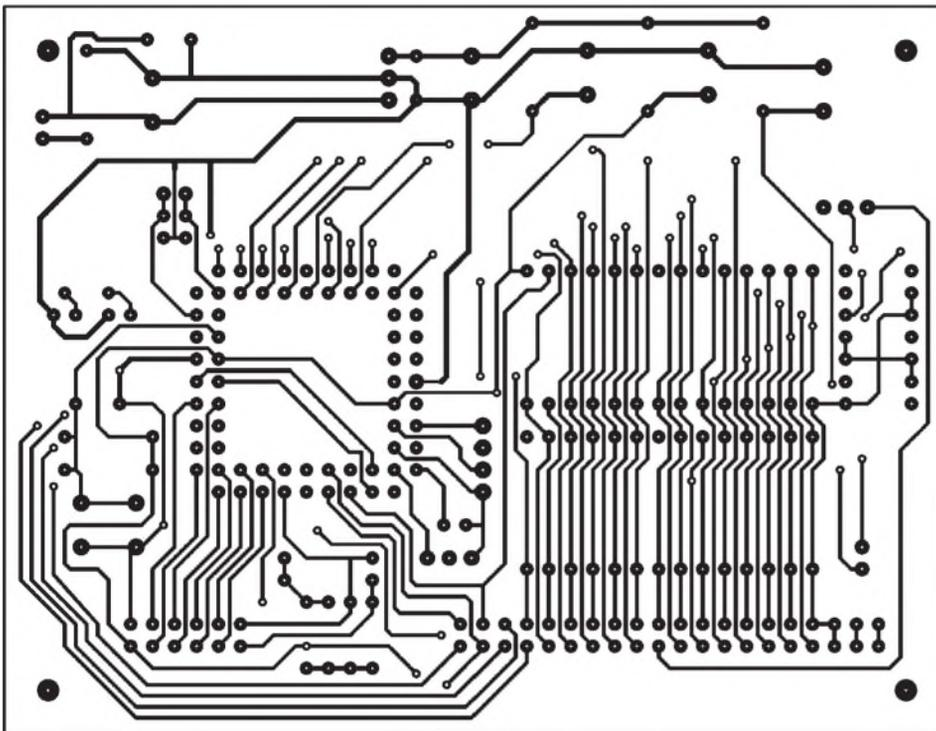
Bild 12: Platinenlayout der Bestückungsseite
