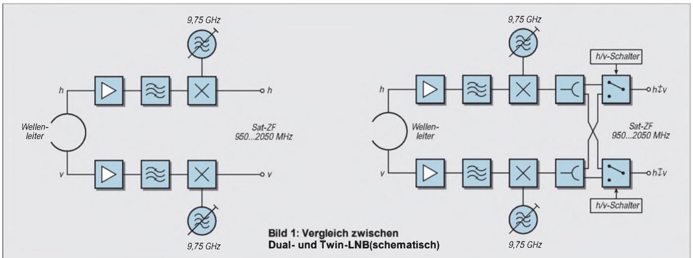
Bild 1: Vergleich zwischen Dual- und Twin-LNB (schematisch)
