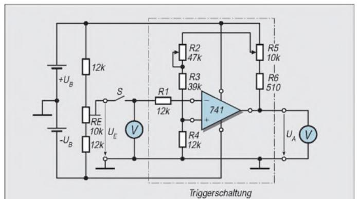
**Bild 4:** Triggerschaltung mit einem Operationsverstärker vom Typ 741 zum Aufbau als Experimentierschaltung. Die Teile außerhalb der farbig eingerahmten Triggerschaltung sind für die Untersuchung der Arbeitsweise und zum Aufnehmen der Arbeitskennlinien (Bild 3) vorgesehen (vgl. Text).
