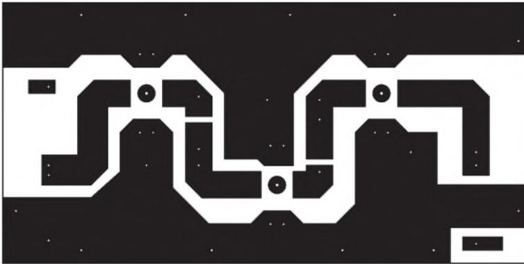
**Bild 2:** Leitungs-führung der Platine für die 70-cm-Leistungs-verstärker-Baugruppe
