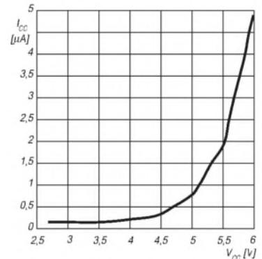
**Bild 8: Power-Down-Betriebsstrom bei passivem Watchdog-Timer ( $T_A = 25\text{ °C}$ )**
