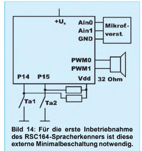
Bild 14: Für die erste Inbetriebnahme des RSC164-Spracherkenners ist diese externe Minimalbeschaltung notwendig.
