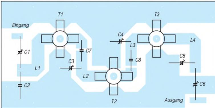
**Bild 3:** Bestückungs-plan der 70-cm-Leistungs-verstärker-Baugruppe, s. auch Text
