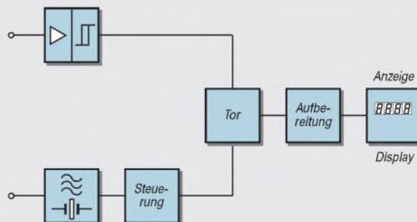
**Bild 2:** Unsere Grundschialtung eines Universalzählers zeigt (konzentriert) als Blocksymbole eine Eingangsschialtung mit Schalltrigger, eine Zeitbasis mit daran anschließendem Steuerungsblock (Impulsformer, Vervielfacher bzw. Teiler), eine Torschaltung und den Anzeigeteil.
