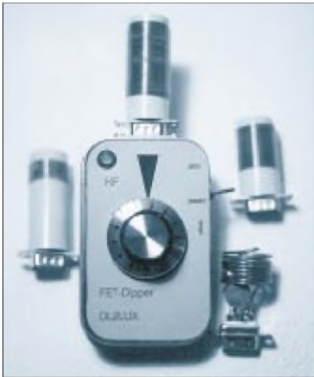
Bild 2: Vorderansicht des FET-Dippers mit LED-Anzeige in der Apothekenschachtel. Links oben die optische Anzeige, rechts der Schalter aktiv – passiv, seitlich darunter das Potentiometer für die Empfindlichkeit und in der Mitte der Drehknopf mit Skale.
