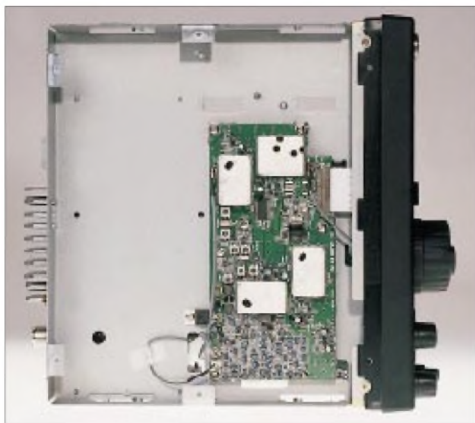
Unter dem Chassisblech sieht es dank der durchgängig eingesetzten SMD-Technik besonders geräumig aus. Hier ist die lediglich die PLL-Einheit untergebracht, auf der ganz logisch auch die Empfänger-eingangs- und Senderzwischenstufen beheimatet sind.
