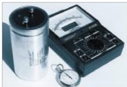
Kapazitätswerte, bestimmt mit Uhr und Multimeter Foto: DJ3RW
