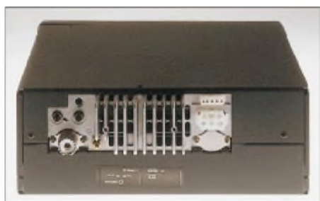
Die Rückseite des DX-77E enthält Buchsen für die Antenne, die Steuerung eines externen automatischen Antennenabstimmgeräts, die Stromversorgung, zum Schalten eines Relais in einer externen Linearendstufe, für die ALC-Spannung von einer Endstufe und eine „Fernsteuerungsbuchse“, z.B. zum Clonen der Transceivereinstellungen von/zu einem zweiten DX-77.
