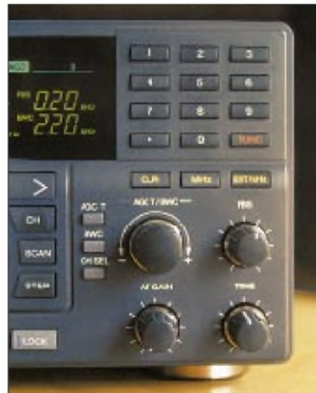
Auf der rechten Frontseite befinden sich u.a. die Steller für AGC, Bandbreite (BWC) und Paßband-Shift (PBS), mit deren Hilfe sich erstaunliche Ergebnisse in besonders kniffligen Empfangssituationen erzielen lassen.
