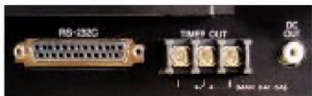
Eine RS-232C-Schnittstelle ist beim NRD-545 bereits eingebaut. Hierüber erfolgt auch die Datenausgabe des integrierten RTTY-De-modulators an einen PC-Bildschirm. Rechts daneben findet sich der Schaltausgang zur Steuerung eines Recorders.
