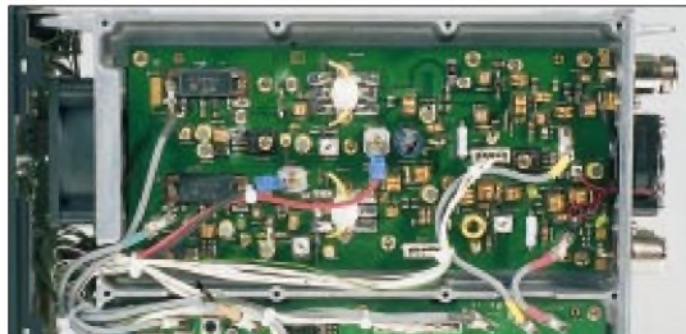
Die Kammer für die drei Endstufen, KW plus 6 m, 2 m bzw. 70 cm, befindet sich links oben vor den Antennenbuchsen.
