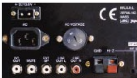
Die Anschlußmöglichkeiten auf der Rückseite des NRD-545 lassen kaum einen Wunsch unerfüllt. Man beachte die Line-Ausgänge für den linken und rechten UKW-Stereokanal (bei installiertem Frequenzkonverter).
