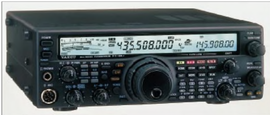
Frontansicht des Zwölfband-Transceivers FT-847. Die geringe Größe des Geräts und die vielen Features erfordern eine recht gedrängten Anordnung der Bedienungselemente.
