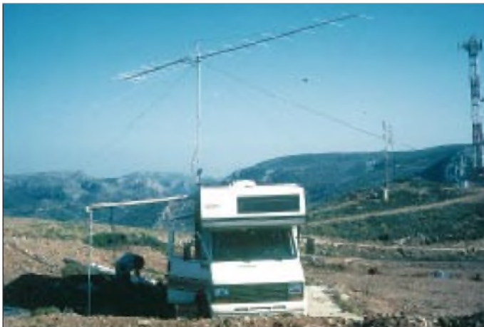
Die 2-m-Meteorscatter-Station: Von hier aus gelangen mit 3CX800 an einer 17-El.-M 2 etliche QSOs über mehr als 2000 km.
