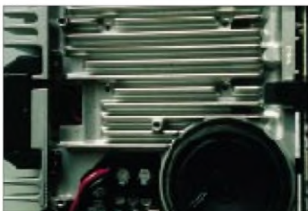
Die Gehäusekonstruktion sorgt für sichere Wärmeableitung.
