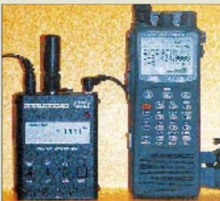
**Der Zähler Mini Scout (I.) von Optoelectronics kann Frequenzen zu einem Scanner, hier dem neuen AR 8200 von AOR, übertragen.**
