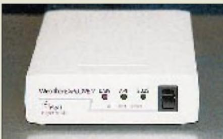
**Der unscheinbare Weather Explorer von orbit electronic ist eine kompakte Wettersatelliten-Empfangsanlage für NOAA und Meteosat.**
