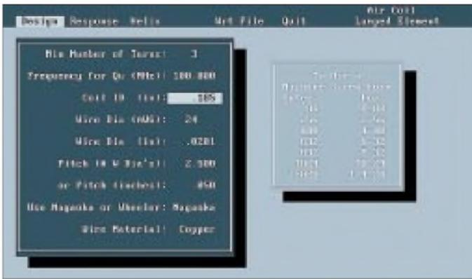
**Bild 3:** Hier werden die Spulendaten bei COIL eingegeben.
