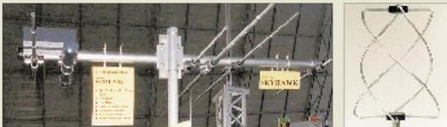
**Die Skyhawk von Bencher hat als Besonderheit einen Drehimpulskompensator (das schwarze Rohr im Bild links). Die C-Quad 137 von RF-Systems zum Wetterbildempfang (Bild rechts)**
