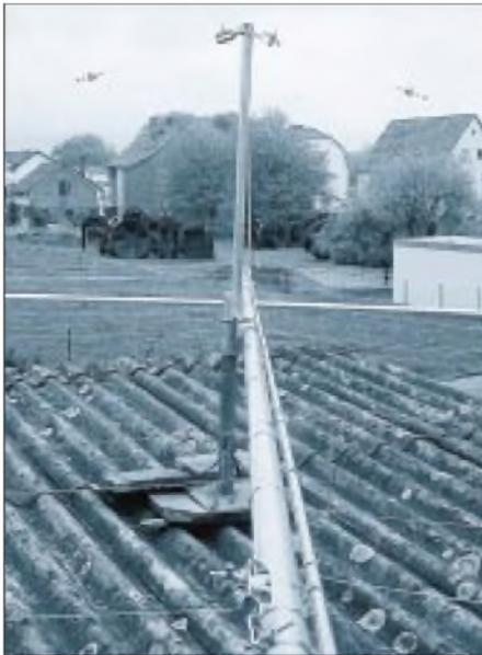
**Bild 5: Der Doppelboom mit den Drahtelementen**
