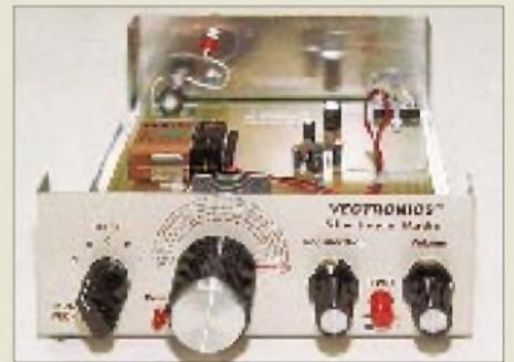
Der VEC-104 von Vectronics ist ein einfacher KW-Audion-Bausatz für 3,5 bis 22 MHz in fünf Teilbereichen.
