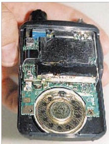
**Blick ins Innere: Sandwichartig liegen mehrere gut abgeschirmte Leiterplatten übereinander. Links oberhalb des Lautsprechers befindet sich die Spule des Spannungswandlers. Der Lautsprecher selbst zehrt vom Restvolumen und liefert dadurch einen guten Klang.** Fotos: Autor
