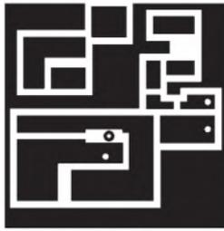
**Bild 5: Leitungsführung der Verstärker-Platine (HF-Verstärker und Spannungsstabilisierung), M = 1:1**
