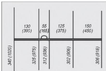
**Bild 1: Dimensionierung einer 5-Element-Yagi für das 70-cm-Band (2-m-Band)**
