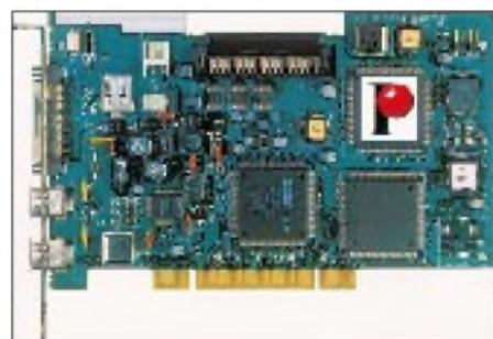
Die miroVIDEO DV 300 ermöglicht Videoschnitt komplett digital. Im Lieferumfang der Karte enthalten sind die Software miroVIDEO DVTools, miroINSTANT Video sowie die Schnittsoftware Adobe Premiere 4.2 LE zur Weiterbearbeitung des Videomaterials.
