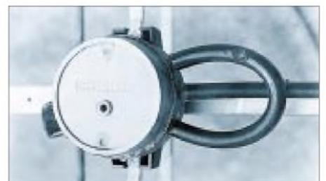
**Bild 9:** Anpassung/Symmetrierung für 70 cm mit einer Umwegleitung
