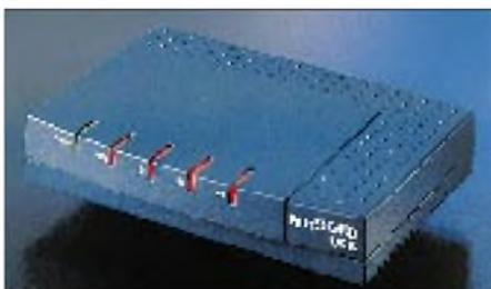
**Die externe FRITZ!Card USB ermöglicht neben dem ISDN-Zugang zum Internet auch Telefax mit 2 x 14.4 Kbps, Dateitransfer, Mailboxzugang und bietet einen PC-gestützten Anrufbeantworter.**
