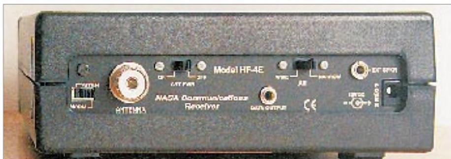
Auf der Rückseite des Empfängers finden sich alle notwendigen Anschlußmöglichkeiten sowie einige Schalter, für die auf der Frontplatte kein Platz mehr war. Wird die als Zubehör lieferbare Aktivantenne NASA AA-30 verwendet, erfolgt deren Stromversorgung direkt aus dem Empfänger (Schalter „ANT PWR“). An der Buchse „DATA OUTPUT“ liegt das vom eingebauten Modem für die weitere Verwendung in einem PC zur Verfügung gestellte Signal.
