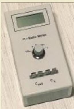
Wenn es nicht auf die Absolutwerte, sondern die möglichst genaue Chargen-Übereinstimmung von Kondensatoren ankommt, ist ein C-Vergleichs-Meter das Meßgerät der Wahl.
