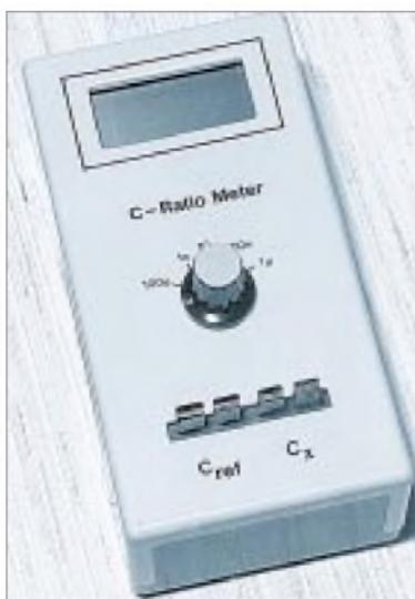
**Bild 5: Das beschriebene Meßgerät gestattet den Vergleich von C<sub>s</sub> im Bereich <100 pF...1µF.**
