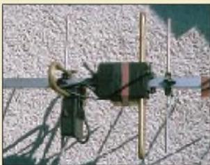
Eine Möglichkeit, zirkulare Polarisation zu erreichen, ist der Versatz der Elemente um  $\lambda/4$  auf dem Tragerohr
