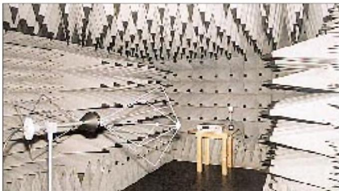
Blick in die Absorberhalle eines Prüflabors. Im Vordergrund die bikonische Antenne HK 116 von Rohde & Schwarz, im Hintergrund ein Prüfling (EUT = Equipment Under Test) sowie ein isotroper Feldstärkesensor mit optischer Schnittstelle
