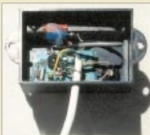
Das Herz der Steuerungszentrale ist der genaue Uhrentakt vom Zeitzeichensender DCF77, empfangen mit einem Standard-RX-Modul.
