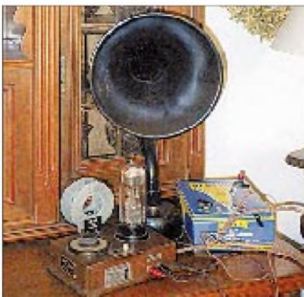
**Bild 1:** Die komplette Empfangsanlage mit OE-333, Anodenbatterie, Heizakkumulator und Trichterlautsprecher
