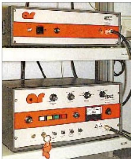
**Hochfrequenzverstärker für den Bereich 10 kHz bis 1000 MHz mit einer garantierten Ausgangsleistung von 100 W an jeder Last und bei jedem Stehwellenverhältnis ohne Reduzierung oder Abschaltung der Ausgangsleistung**
