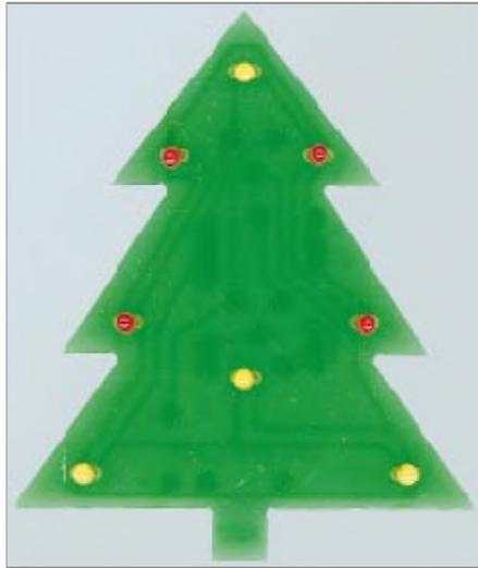
Beim elektronischen Weihnachtsbaum handelt es sich um eine kleine Elektronikanwendung eines astabilen Multivibrators, bei dem zweimal vier LEDs mit integriertem Vorwiderstand parallel geschaltet sind. Die Platine wird ausgefräst geliefert.
