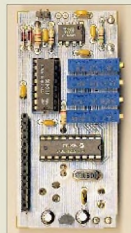
Ein MC12079 (oben) verleiht dem PIC-Display Flügel...
