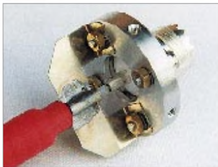
Bild 6: Übergang Buchse – Koaxialleitung
