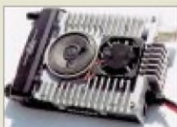
Der FT-90 ist nur 100 x 30 x 138 mm³ groß und bringt ganze 600 g auf die Waage
