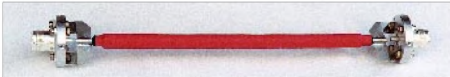
Bild 8: Fertig montierte Innenleitung der Mantelwellensperre
