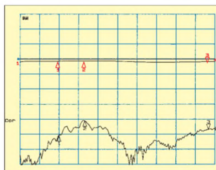
Bild 5: Gleichtaktunterdrückung des Filters im Frequenzbereich 300 kHz bis 150 MHz; vertikal 10 dB/Rastereinheit (untere Kurve). Bei den Frequenzen 30 MHz (Marke 1), 50 MHz (Marke 2) bzw. 145 MHz (Marke 3) betragen die Gleichtaktunterdrückungswerte 51 dB, 41 dB bzw. 46,7 dB.
