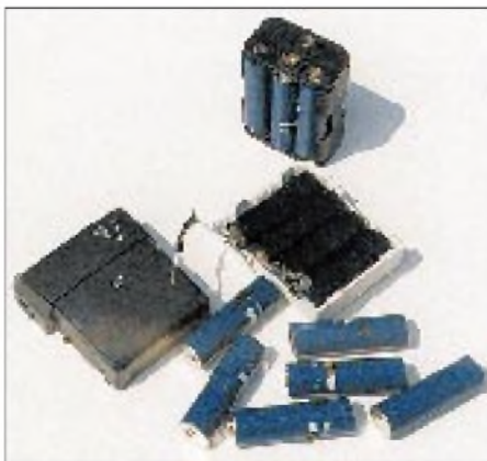
Die vier Zustände auf einem Bild: links die Akkukassette von einem schnurlosen Telefon (schwarz), rechts eine geöffnete Akku-Kassette mit vier Mignon-NiCd-Zellen und den Verbindungsstege. Unten sechs für gut befundene, nun getrennte Einzelzellen; oben ein neu zusammengestellter Akkupack mit sechs Zellen Foto: DJ3RW
