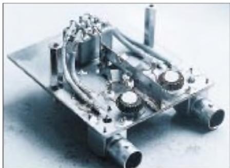
Bild 13: Keramik-Vorfilter-Versuchsaufbau von HB9JNH/AFR Fotos: DJ2EV
