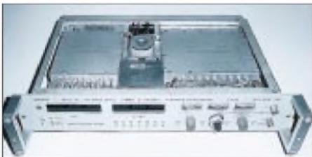
**Bild 1:** Nur durch enormen Aufwand läßt sich ein präzises Frequenznormal mit dem Langwellensender DCF-77 aufbauen. Es besteht aus Empfänger (links), TCXO (Mitte vorn), digitalem Frequenzdiskriminator (rechts) und acht Ausgangspuffern (rechts hinten). „Abfallprodukt“ ist die genaue amtliche Zeit.
