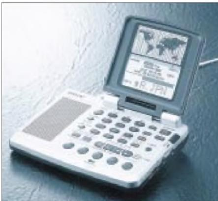
Der ICF-SW07 im „Laptop-Design“ wird ab April für 799 DM (UPE) zu haben sein. Er verfügt über Synchrondetektor, NF-Ausgang, Weltzeituhr, Timer und demoduliert bei einer Abstimm-schrittweite von 1 kHz auch Einseitenband-Signale.
