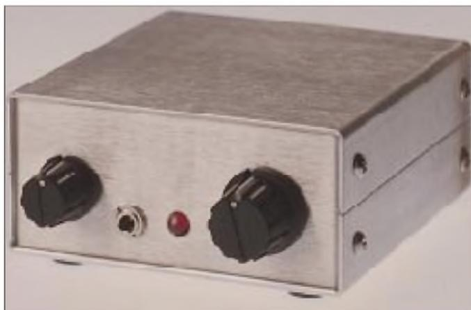
**Frontansicht des SST. Bedienelemente sind lediglich Abstimmung und Empfangslautstärke. Außerdem befindet sich der Kopfhöreranschluß an der Frontseite. Die LED ist die AGC-Diode D3.**
