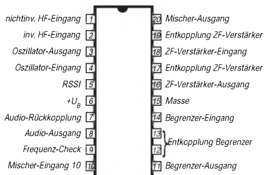
Bild 2: Pinbelegung für alle Gehäusevarianten
