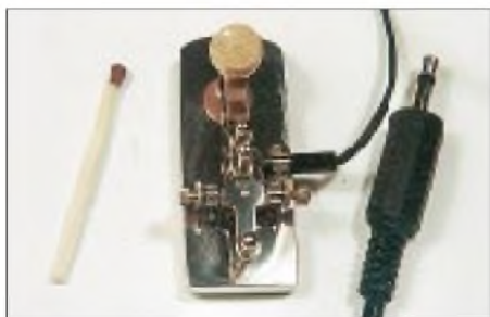
Diese handgefertigte Morsetaste im Miniaturformat ist weniger zur Telegrafieübung gedacht. Aber im Urlaubsgepäck, zusammen mit der QRP-Station, darf sie nicht fehlen. Foto: DF9IV
