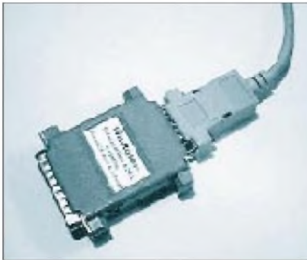
Bild 2: WinRotor32, ein Aufsteckinterface zum Anschluß an den Druckerport
