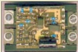
Die Leiterplatte der QRP-Endstufe 97-03
