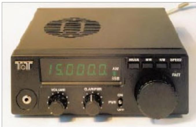
Das betriebsbereite Gerät. Unten 3,5-mm-Stereo-Klinkenbuchse, Lautstärkesteller, Clarifier, Einschalter, Hauptabstimmung. Oben das sechsstellige Display (AM bzw. SSB durch je eine LED rückgemeldet), Taster SSB/AM, Memory In/Out, Umschaltung auf 100 kHz oder 2,5/5 kHz je nach Betriebsart. Die LED zwischen SPEED und FAST ist während der Montage der Displayleiterplatte einzupassen.
