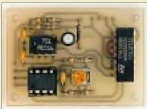
Auf der Suche nach einem Eingabelement, mit dessen Hilfe eine Up/down-Steuerung sowie eine gleichzeitige kontinuierliche Beeinflussung der Änderungsgeschwindigkeit erfolgt, entstand diese Baugruppe. Foto: DM2AUO
