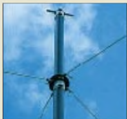
Steckbare, 1,5 m lange und 60 mm dicke Glasfaserrohre sowie ein Alu-Kopfstück zeichnen diesen Mast gegenüber den Angelruten aus.
