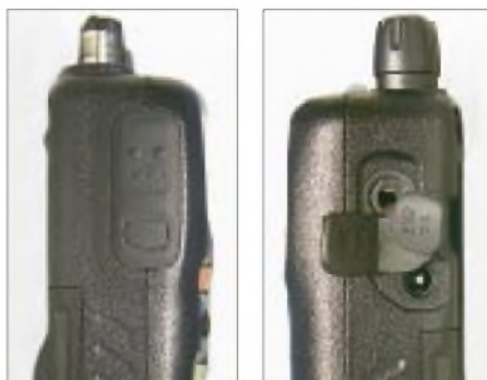
Die unter der Sendetaste liegende Tonruftaste schaltet zugleich den Sender.
