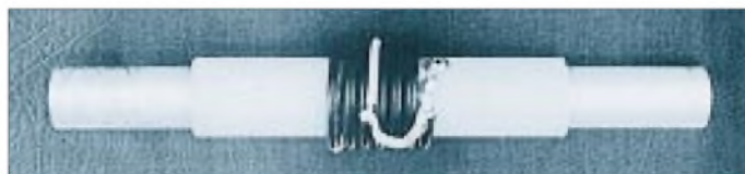
Bild 4: Ein fertiger Trap mit Zwischen-Rohrstücken
