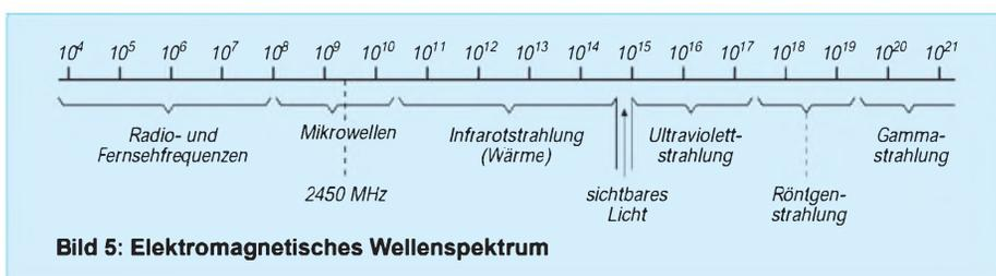
Bild 5: Elektromagnetisches Wellenspektrum
