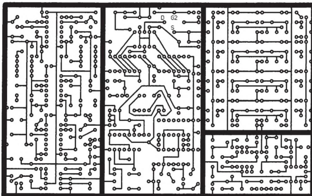
Bild 11: Leitungsführung der Platine für den Direktmischempfeänger
