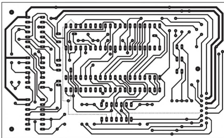
Bild 7: Platinenlayout Displayplatte
