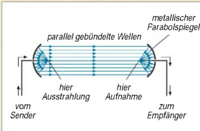
Jeder Wellenlängenbereich hat seine Besonderheiten. Im GHz-Bereich zeigen die Funkwellen stark lichtähnliches Verhalten. Durch spezielle Antennen lassen sie sich bündeln und z.B. auf einen fest im Orbit positionierten Satelliten o.ä. richten.
