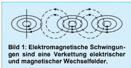
**Bild 1: Elektromagnetische Schwingungen sind eine Verkettung elektrischer und magnetischer Wechselfelder.**
