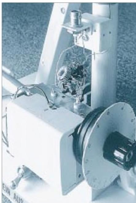
**Bild 8: Drehkondensator mit angeschlossenem Puffer und BNC-Ausgangsbuchse**
