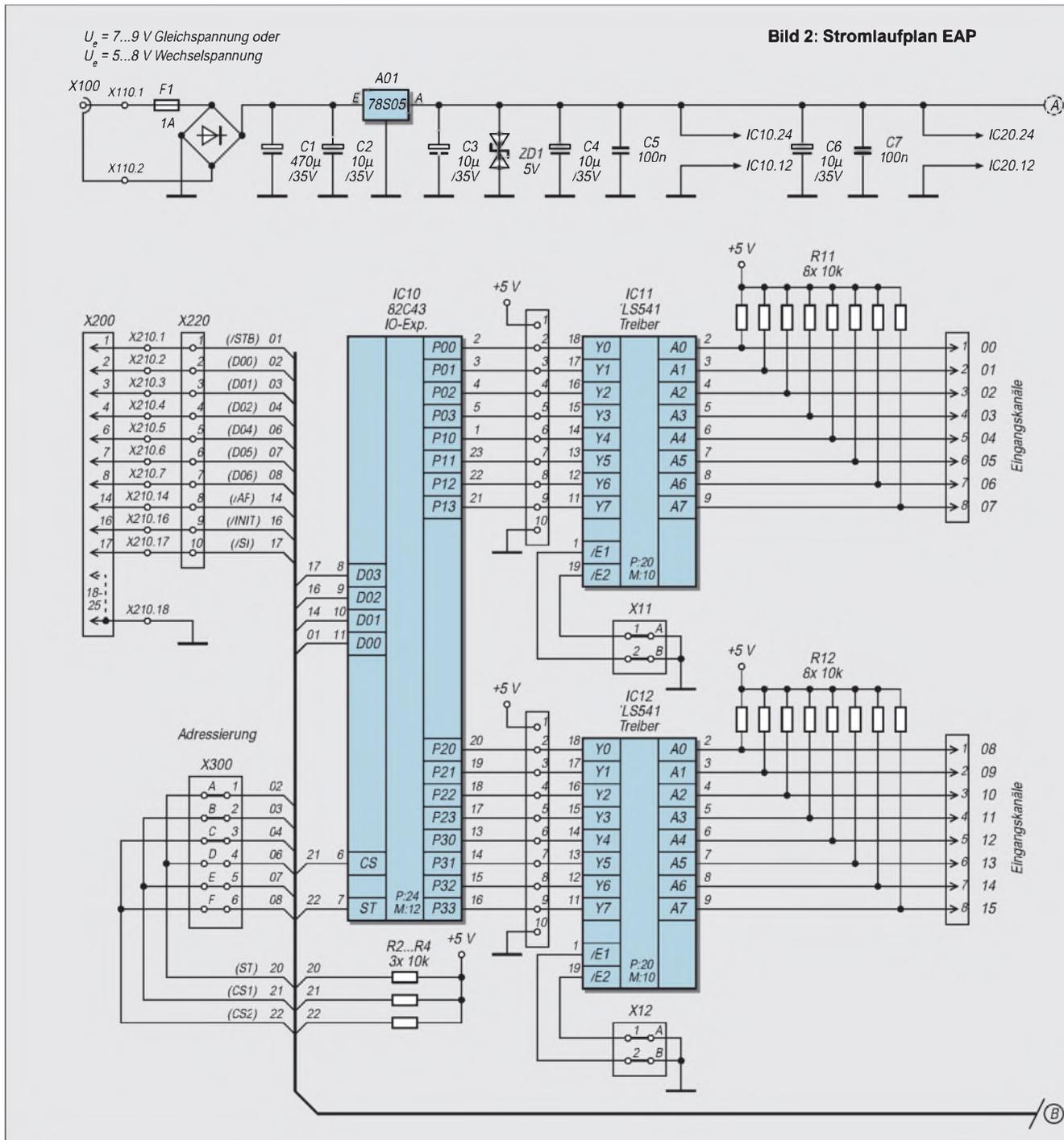
(LDA oder SSA). Die über die Pfostenleisten X11/12 geführten Enable-Eingänge der Treiber können für eigene Zusatzverknüpfungen verwendet oder durch Drahtbrücken realisiert werden.
