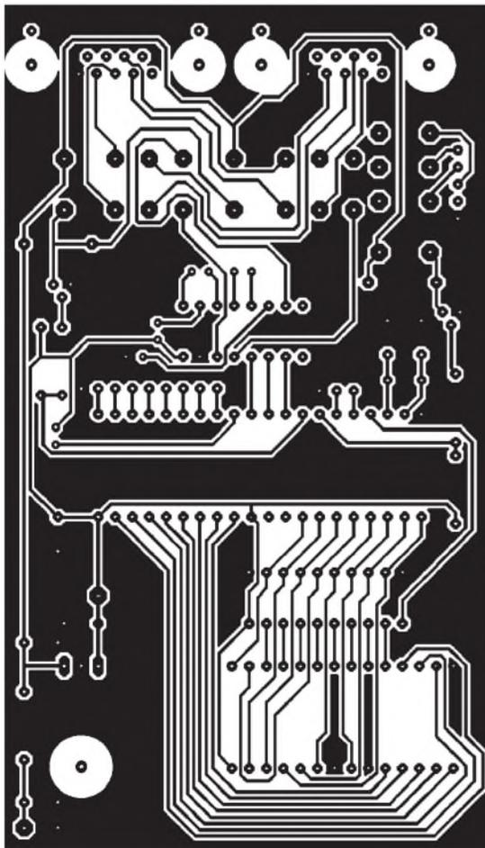
**Bild 4:** Leitungsführung der Platine für den DSK-Loader
