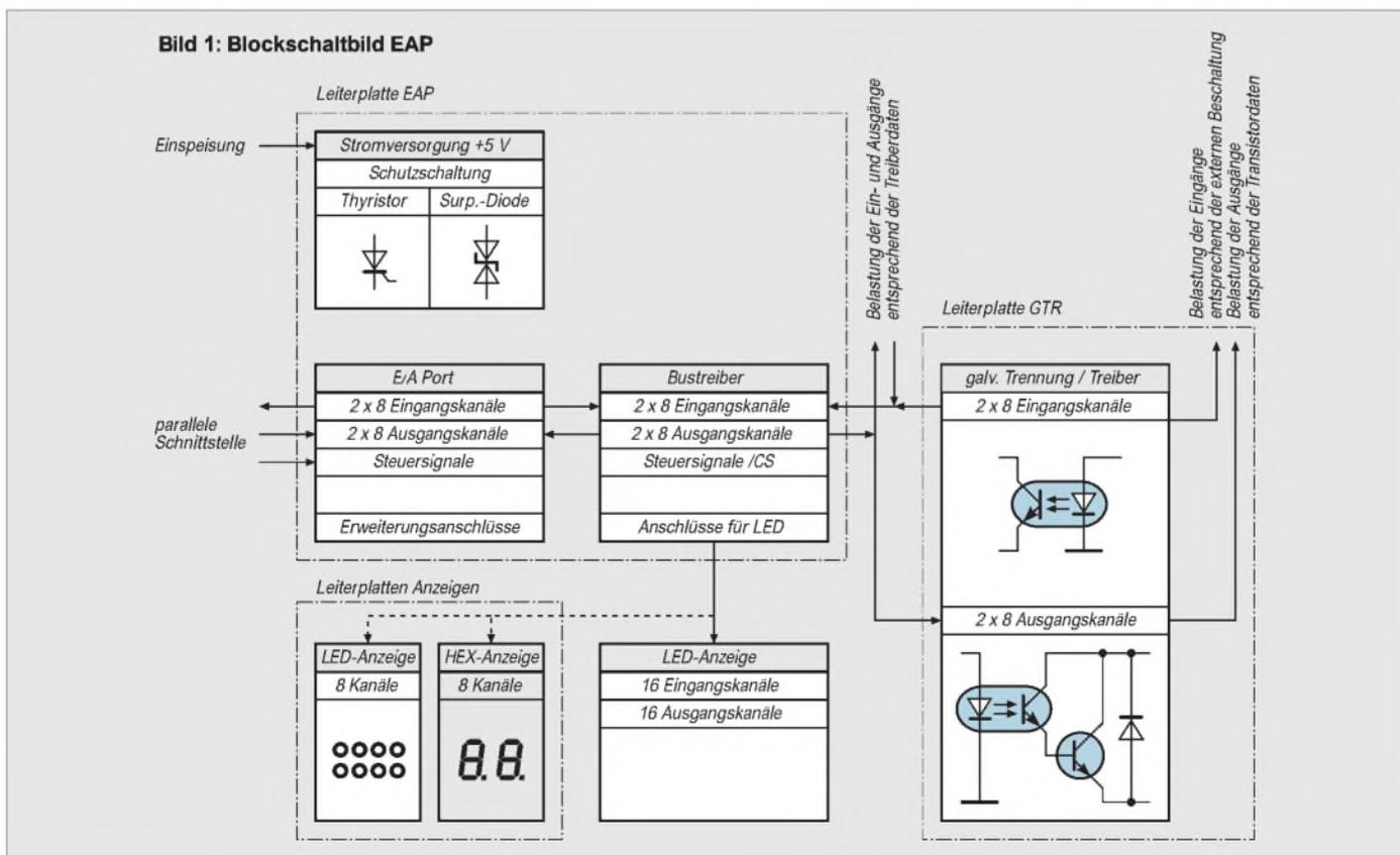
Wird zusätzlich die Baugruppe GTR über die Steckleiste X2 angeschlossen, ist zu beachten, daß sich der Strombedarf für jeden durchgeschalteten Ausgangs-Kanal um ca. 20 mA erhöht. Dies ist je nach Einsatz des Moduls bei der Dimensionierung des Kühlkörpers für A01 zu beachten.
