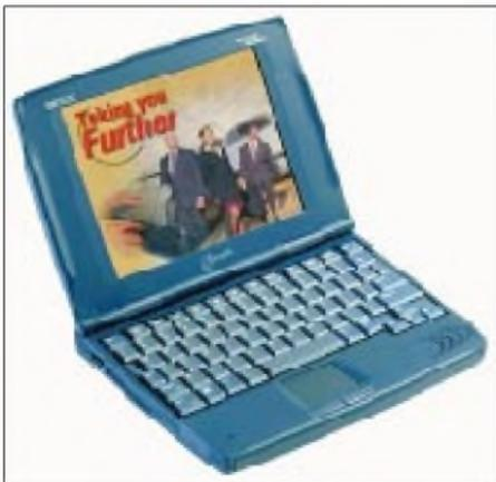
**Bild 1:** Der Jornada ist mit seinem 8,2-Zoll-Farbdisplay deutlich besser als ein normaler Handheld-PC. Die Tastaturbedienung ist fast so komfortabel wie bei einem Desktop-PC.
