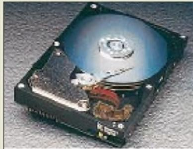
mit 7200 Umdrehungen/Minute statt wie bisher mit 5400 Umdrehungen und sind mit GMR-Köpfen (GMR = Giant Magneto-Resistive), der Highspeed-Schnittstelle Ultra ATA/66 und dem Datenschutzsystem Data Lifeguard ausgestattet. ATA/66 ermöglicht eine Datenübertragungsrate von bis zu 66,6 MB/s, während das Data-Lifeguard-System mögliche Systemausfälle schon prognostiziert, Fehler isoliert und korrigiert, bevor ein Datenverlust auftreten kann.
