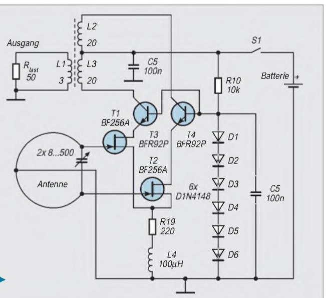
Bild 6: Stromlaufplan des Puffers
