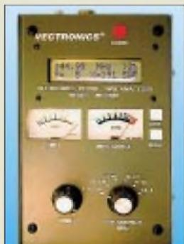
Batteriebestückt nur 840 g schwer und 103 x 172 x 62 mm<sup>3</sup> groß, reicht dieses in SMD-Technologie aufgebaute Vielfachmeßgerät von 1,8 bis 170 MHz.
