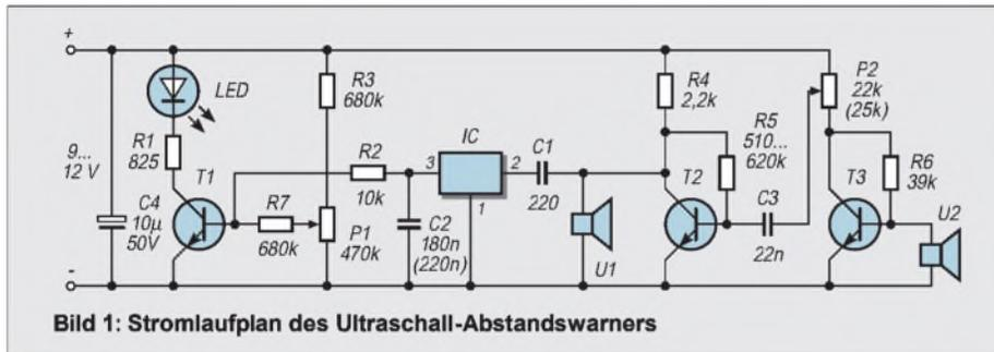
Bild 1: Stromlaufplan des Ultraschall-Abstandswarners
