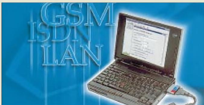
Für den portablen Einsatz im Notebook steht eine Typ-III-PCMCIA-Karte zur gleichzeitigen Analyse von bis zu acht Kanälen zur Verfügung.
