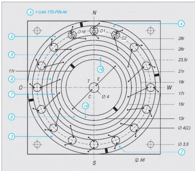
**Bild 2: Mechanisch hergestellte Platine und Verdrahtung des Anzeigemoduls**
