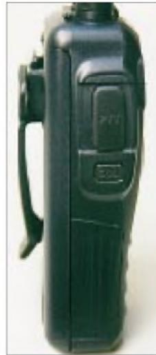
Im Profil ist das Gehäuse sehr schlank. Unter der großen, angenehmen zu bedienenden Sendetaste liegt die Rauschsperrtaste.
