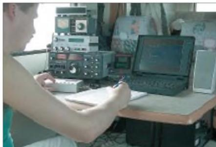
**Guido, EA1/DL8EBW, an der Station. Die Endstufe (Discovery 3CX800A7) steht unten und wärmt das Wohnmobil. Weiterhin zu sehen sind der FT-225 (Mutek), SSB-RX-VV, DTR, DSP und das Notebook mit OH51Y-Software.**
