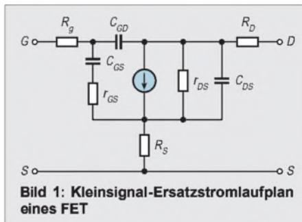
Bild 1: Kleinsignal-Ersatzstromlaufplan eines FET
