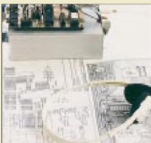
Der DSK-Loader macht aus dem DSP-Starterkit von TI ein komplettes umschaltbares DSP-NF-Filter. Foto: DL4JAL
