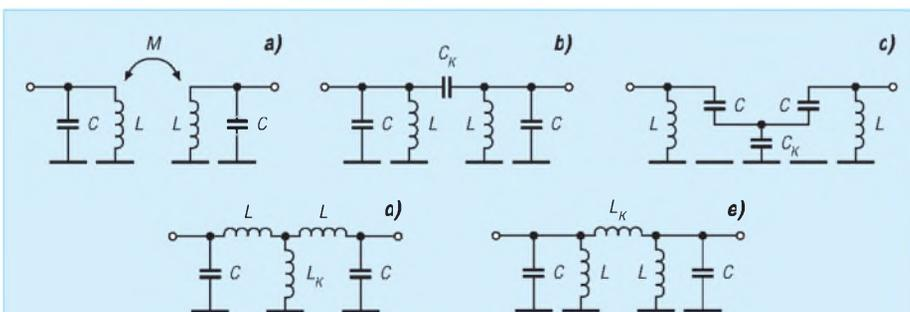
**Bild 1:** a) Kopplung über Gegeninduktivität, b) kapazitive Hochpunktkopplung, c) kapazitive Tiefpunktkopplung, d) induktive Tiefpunktkopplung, e) induktive Hochpunktkopplung
