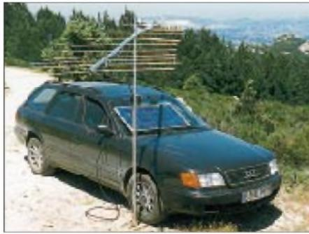
IWO/DG0ZB/p, auf dem Monte Limbara (JN40OU) in 1300 m Höhe ü. NN. Mit ein paar Watt (aus Sonnenkollektoren) an einer 12-Ele.-M<sup>2</sup> gelangen Knut am 5.6. Verbindungen bis 912 km (ODX in JN28).
