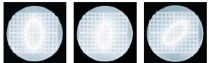
**Bild 14: Oszillogramme, die die Pasenverschiebung zeigen. Links – 90°, o.k.; Mitte – Frequenzbereich überschritten; rechts – totale Fehlfunktion**
