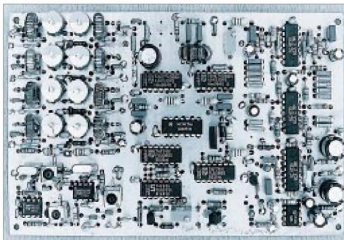
**Bild 13: Die fertige Leiterplatte des Direktmischempfängers**
