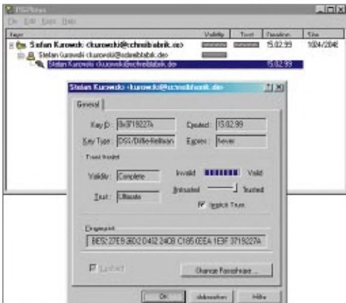
Ein Beispiel für die Informationen, die zu jedem Schlüssel hinterlegt werden können. Damit erleichtert PGP dem Anwender die Einschätzung der Sicherheit des fremden Schlüssels.
