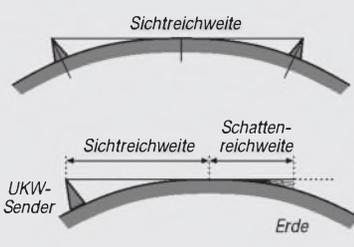
**Bild 10: Schema der UKW-Ausbreitung**
