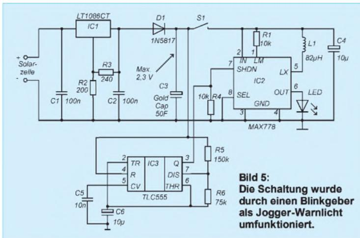
**Bild 5:** Die Schaltung wurde durch einen Blinkgeber als Jogger-Warnlicht umfunktioniert.
