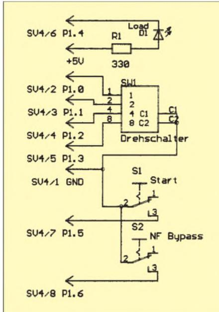
**Bild 3:** Bedienelemente für den DSK-Loader (links die Bezeichnungen der korrespondierenden Punkte auf der Leiterplatte). D1 blinkt, wenn die DSK-Datei geladen wird, leuchtet, wenn die NF über das DSP-Kit läuft, und ist dunkel, wenn die NF durchgeschleift wird. S1 startet das DSK-Laden, S2 aktiviert das Durchschleifen der NF.
