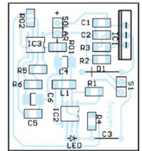
**Bild 6:** Unser Platinvorschlag für das Warnlicht. Sie können aber auch für spezielle Gehäuse aus dem Fahrrad-Ersatzteilhandel das Layout entsprechend ändern.
