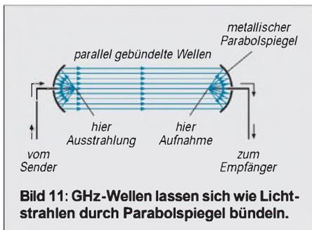
**Bild 11: GHz-Wellen lassen sich wie Lichtstrahlen durch Parabolspiegel bündeln.**
