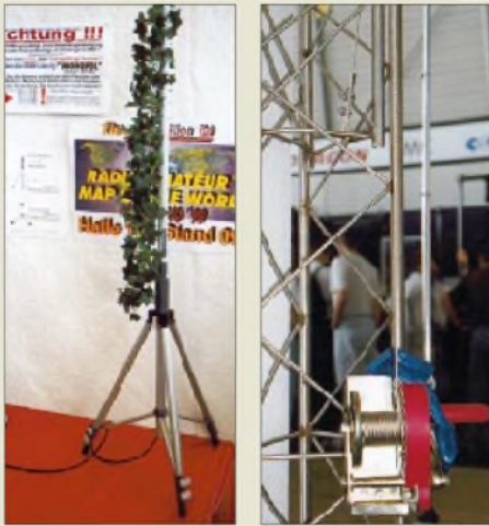
Monopol-Antennen von OE7OKJ (Vertrieb über Traxel) stellen einen offenen Serienschwingkreis dar. Die 160-m-Version mißt nur 3,6 m und die 10-m-Ausführung wiegt bei 21 cm Länge 115 g (ohne Efeu ...). Hochkurbeln - Funken - Herunterkurbeln ist die Devise bei WiMos neuem 3 x 3-m-Mast.
