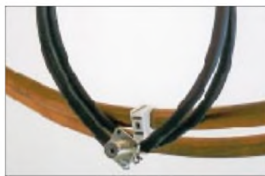
Bild 11: Einkoppelschleife mit zwei Windungen für eine zweischleifige Magnetantenne Fotos: Autor
