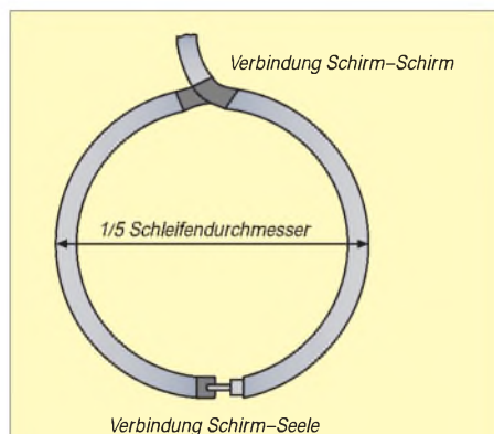
Bild 9: Herstellung der Einkoppelschleife aus Koaxkabel
