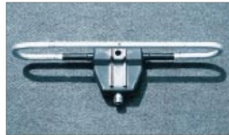
Bild 2: Der WiMo-Faltdipol mit „Posaumentchnik“, zum Abgleich veränderbar
