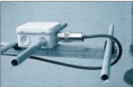
Bild 8: Das Erregerzentrum der 28-Ω-Yagis für das 70-cm-Band
