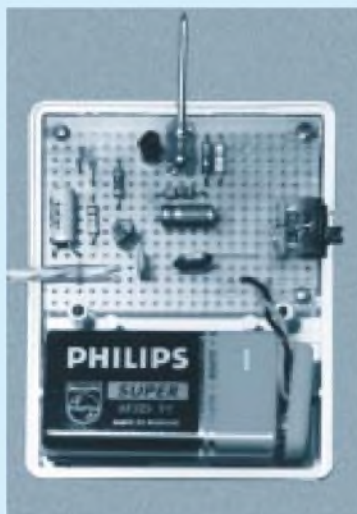
Bild 2: Die Schaltung ist auf einer Lochrasterplatte schnell aufgebaut.
