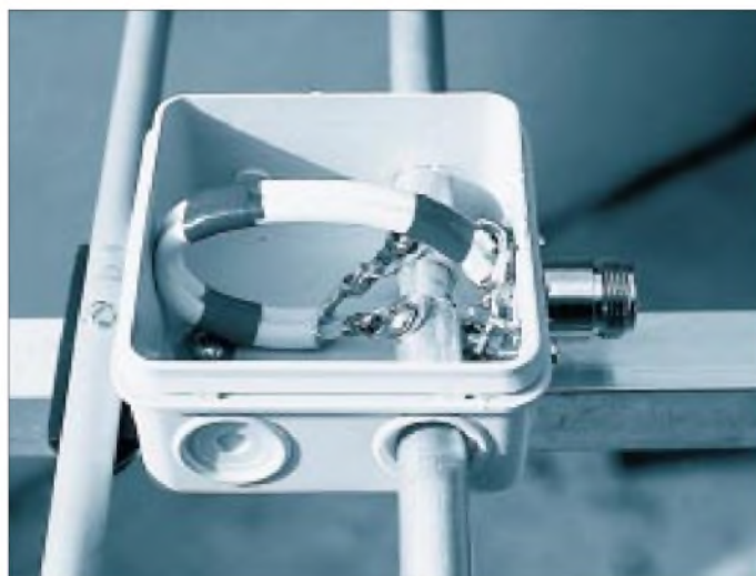
Bild 5: Praktische Ausführung der 28-Ω-Anpassung mit Dose und Koaxbuchse
