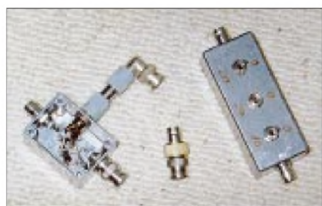
Bild 10: Schaltbares Dämpfungsglied, Abschlußwiderstand und Reflexionsmeßkopf (s. nächste Folge) sind als Zubehör „Pflicht“.
