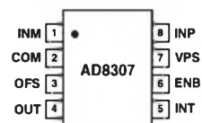
Bild 2: Anschlußbelegung des Schalt- kreises von oben gesehen
