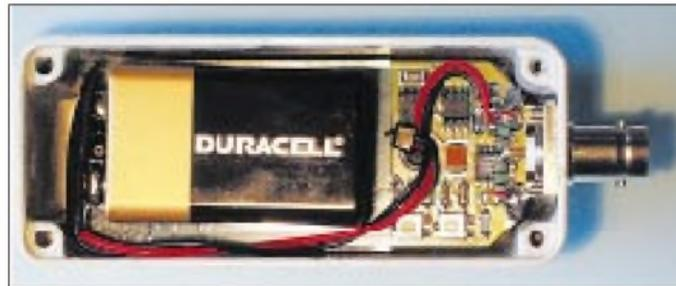
**Bild 1:** Innenleben des Leistungsmeßers PWRM1; Kernstück ist der IS AD8307. Rechts im Bild sind die Abschlußwiderstände unmittelbar an der BNC-Buchse zu erkennen.
