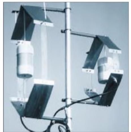
**Bild 3:** Ansicht von zwei Isotronantennen
