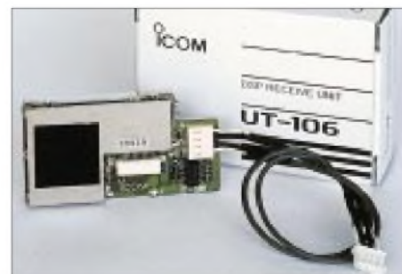
Bild 3: DSP-Einheit UT-106 – ein sehr empfehlenswertes Zubehör
