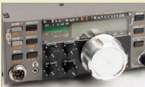
K2 – der QRP-Bausatz der Superlative; besonders hervorzuheben ist die europäischen Verhältnissen angepaßte Großsignalfestigkeit des Empfänger-eingangsteils Foto: ZB
