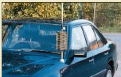
Etwas voluminös, dafür aber DX-tauglich ist diese Spule für die Mobilantenne des Verfassers. Sie stellt die Quintessenz aus lang-jährigen Experimenten dar. Foto: DL9AH
