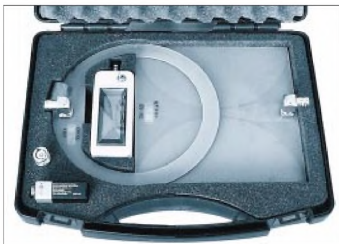
Bild 1: Meßkoffer mit H-Feldsonde HFS1, E-Feldsonde EFS1, Pegelmeßgerät PWRM1, BNC-BNC- Adapter und 9-V-Batterieblock
