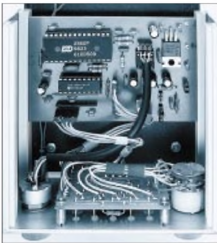
Bild 3: Blick in das geöffnete Gerät, Rückseite und Deckblech sind nicht sichtbar. Oben die Platine MEM-C 03, unten an der Frontplatte MEM-C 04.
