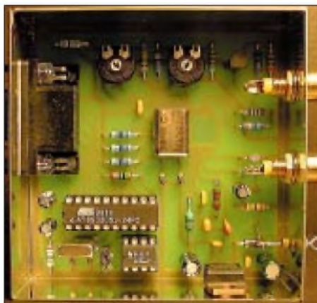
Bild 7: Fertig bestückte Platine, in einem Standard-Weißblechgehäuse untergebracht
