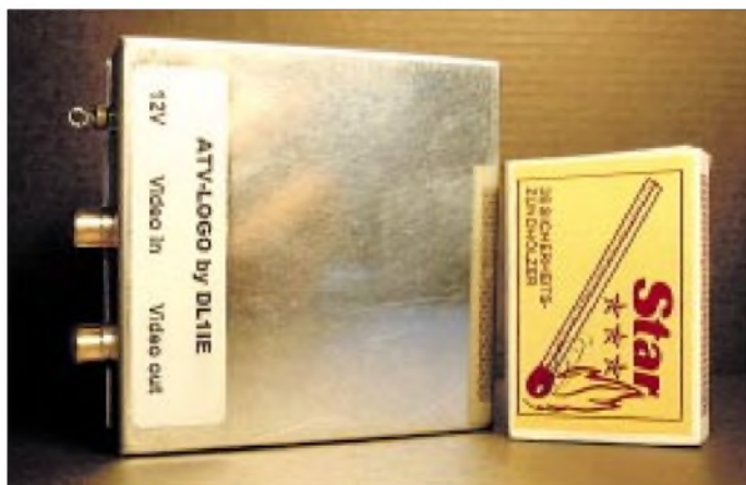
Bild 1: Ein Weißblechgehäuse mit den Maßen 74 mm × 74 mm × 30 mm nimmt die Baugruppe auf und sorgt gleichzeitig für HF-technisch saubere Abschirmung. Die Ein- und Auskopplung des Videosignals erfolgt über Cinch-Buchsen.
