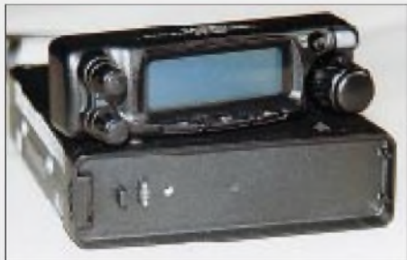
Das Bedienteil ist abnehmbar. Der Kontakt zum eigentlichen Gerät erfolgt über lediglich vier Leitungen.
