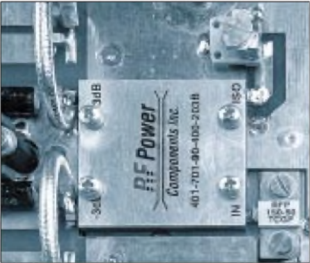
Bild 4: 3-dB-Powersplitter zum Aufteilen bzw. Zusammenfügen des UHF-Signals; rechts unten 50-Ω-Abschlusswiderstand
