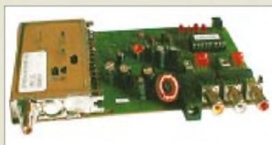
Die gekapselte HF-Baugruppe dieses ATV-Senders läßt sich zur Verringerung des Platzbedarfs hochkant montieren.
