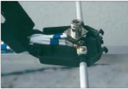
**Bild 3:** In dieser Antennendose ist deutlich die Montage der N-Buchse zu erkennen.
