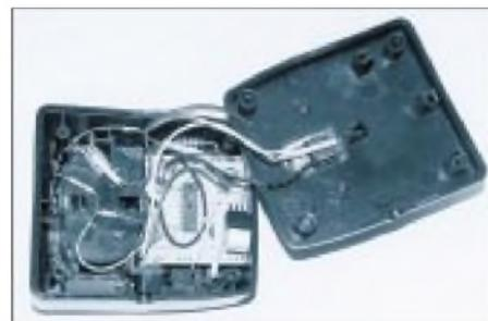
**Bild 9: Geöffnete Ladestation mit kompletter Nachrüstung**
