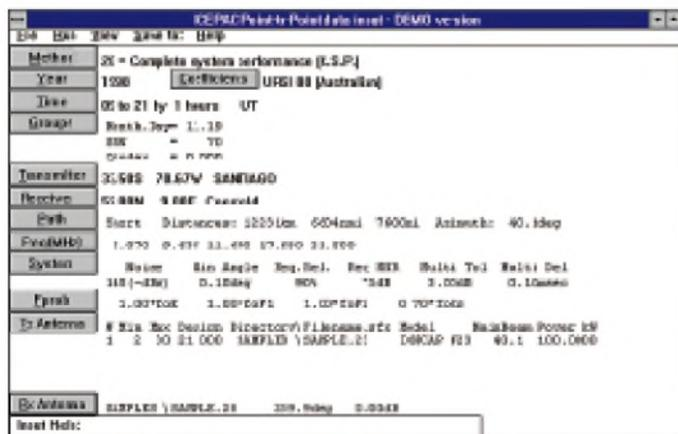
**Bild 1:** Die ICEPAC-Startmaske bietet Zugang zur Eingabe der diversen Ausgangsparameter.
