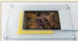
Zwei Glasscheiben und ein Haltewinkel – fertig ist die Platinenhalterung für beidseitige Leiterplattenbelichtung. Foto: Max Perner
