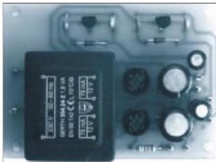
**Bild 23:** Die bestückte und betriebsbereite Netzteilplatine.
