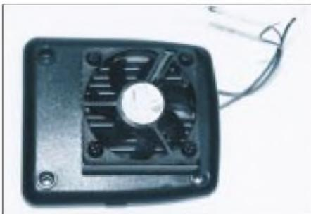
**Bild 8: Gehäuseunterteil mit aufgesetztem Pentium-I-CPU-Cooler**
