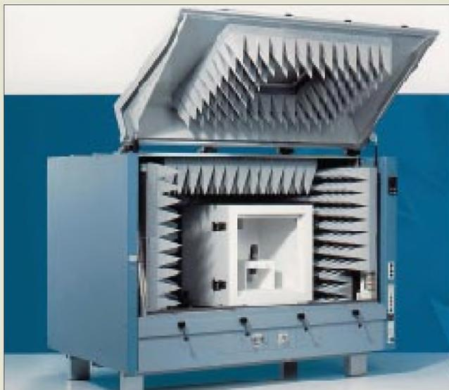
Diese 1,5 m x 1 m x 1 m große Meßzelle gestattet einen maximalen Abstand zwischen Meßantenne und Prüfling von 0,7 m. Eine optionale Temperaturkammer läßt Messungen im Bereich von -25 bis +55 °C zu. Der Innenraum ist vollständig mit pyramidenförmigen Absorbern ausgekleidet.
