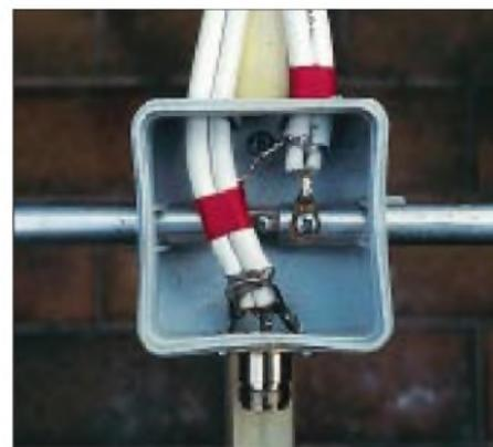
**Bild 11:** Eigenbauvariante einer Dipolanschlußdose unter Verwendung einer Aufputz-Verteilerdose.
