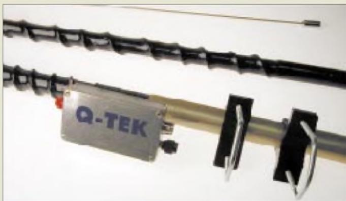
In drei Teile zerlegbar bringt es diese KW-Antenne auf gerade mal 1,5 m Transportlänge.
