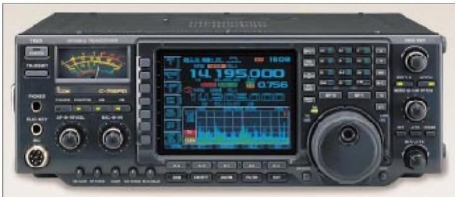
**Bild 1:** Jetzt wird's bunt! Wie schon beim IC-756 beherrscht auch beim IC-756PRO das Display die Frontansicht, diesmal allerdings in Farbe und dank TFT auch von der Seite her bequem ablesbar.
