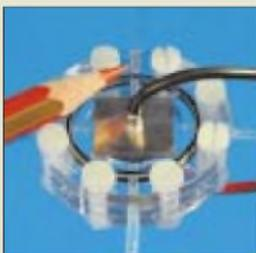
**Der Anwendungsbereich derartiger Brennstoffzellen liegt zwischen 1 und 50 W. Der notwendige DC/DC-Wandler läßt sich in die Elektronik des zu versorgenden Gerätes integrieren.**
