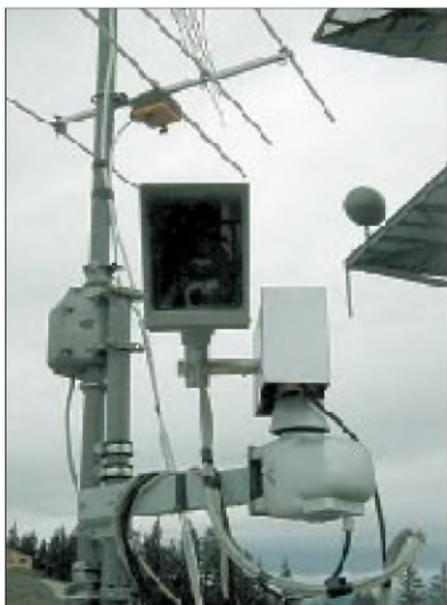
Antennenanlage und Steuergeräte des ATV-Relais
