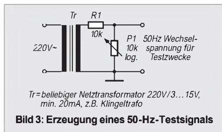
**Bild 3: Erzeugung eines 50-Hz-Testsignals**
