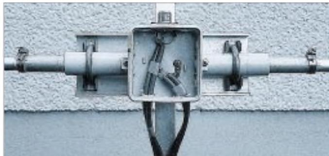
**Bild 13: Aufbau des Strahlerelementes und Blick in die Anpaßdose**
