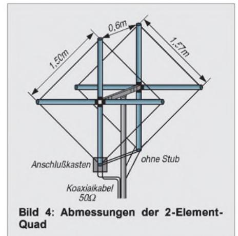
Bild 4: Abmessungen der 2-Element-Quad
