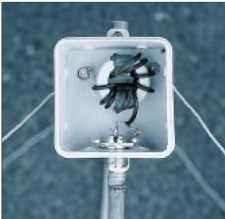
**Bild 6: Der Anschlußkasten mit dem Balun**
