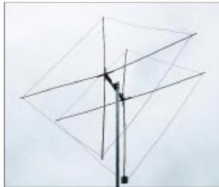
**Bild 8: Fertige 2-Element-Quad im Betriebszustand**
