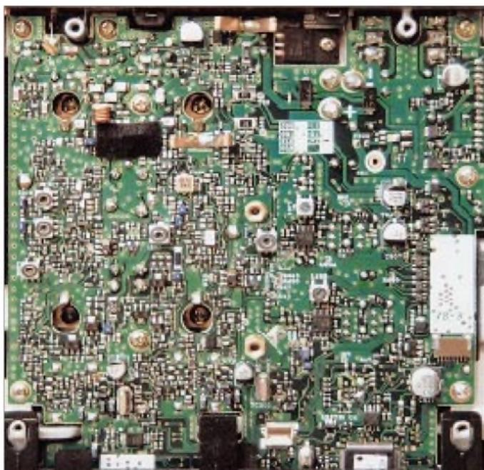
**Bild 4:** Die freiliegende Platine ist dicht mit SMD-Bauteilen in kleinster Bauweise bestückt. Hier läßt sich ein Sprachausgabemodul nachrüsten, und auch der unter Kenwood-Fans wohlbekannte grüne Draht findet sich wieder.
