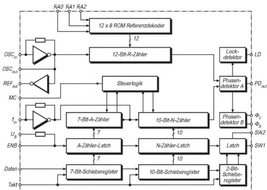
Bild 2: Innenaufbau des PLL-Schaltkreises
