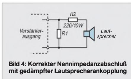
**Bild 4: Korrekter Nennimpedanzabschluß mit gedämpfter Lautsprecherankopplung**
