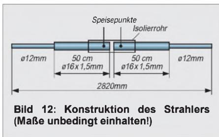
**Bild 12: Konstruktion des Strahlers (Maße unbedingt einhalten!)**
