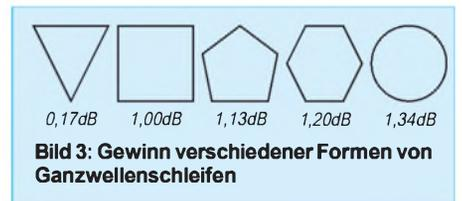
Bild 3: Gewinn verschiedener Formen von Ganzwellenschleifen
