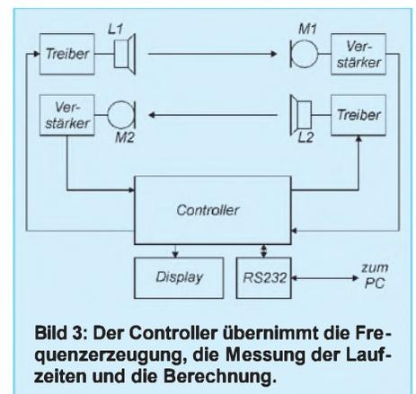
Wir gehen mal davon aus, daß wir den Abstand  $s$  recht präzise messen können. Die Genauigkeit der Windgeschwindigkeit wird dann nur noch durch die Genauigkeit der Zeitmessung beeinflusst.
