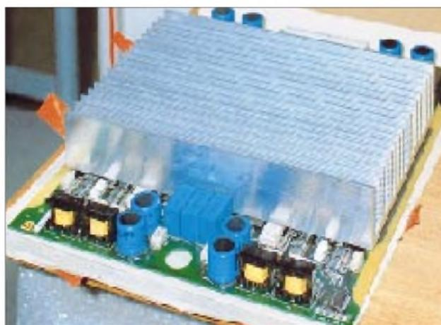
**Bild 6:** Eines der HF-Module, Herzstück des Senders, mit seinem Kühlkörper
