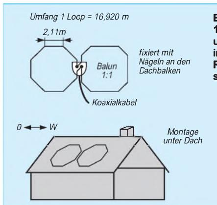
**Bild 6: 15-m-Doppelquad unter dem Dach, in Ost-West-Richtung strahlend**
