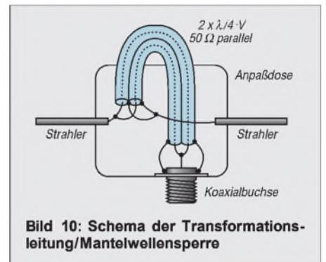
**Bild 10: Schema der Transformationsleitung/Mantelwellensperre**
