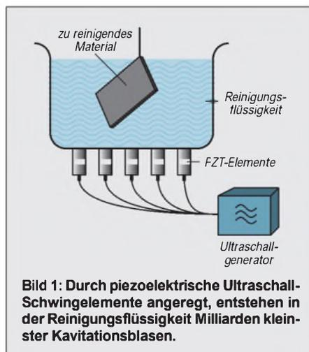
**Bild 1:** Durch piezoelektrische Ultraschall-Schwingelemente angeregt, entstehen in der Reinigungsflüssigkeit Milliarden kleinster Kavitationsblasen.
