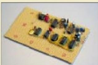
Die Schaltung für den Differential-GPS-Dekoder ist schnell auf einer Lochrasterplatte aufgebaut.
