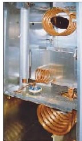
**Bild 4: Tiefpaß des Transistorsenders, links neben dem Scheibenkondensator beginnt die Koaxialleitung.**
