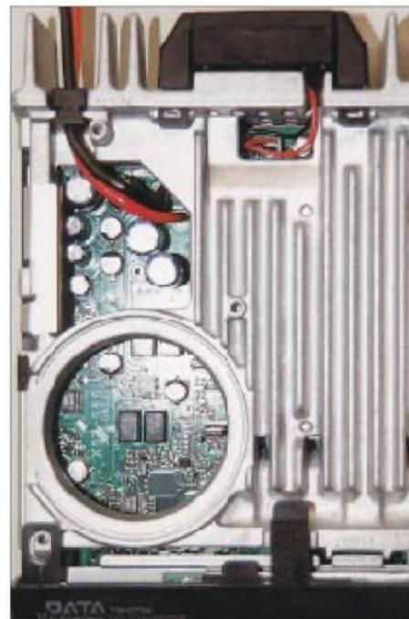
**Bild 5:** Das aufwendige Chassis ist zur Kühlung unverzichtbar.
