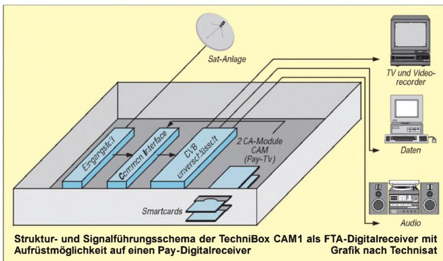
Struktur- und Signalführungsschema der TechniBox CAM1 als FTA-Digitalreceiver mit Aufrüstmöglichkeit auf einen Pay-Digitalreceiver Grafik nach Technisat
