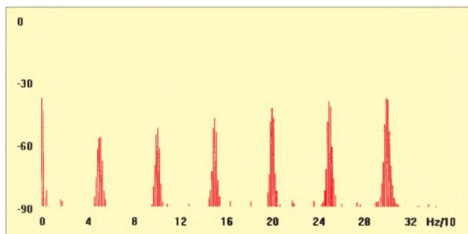
**Bild 1:** Der „Lattenzaun“ im FFT-Display; Bandbreite 320 Hz
