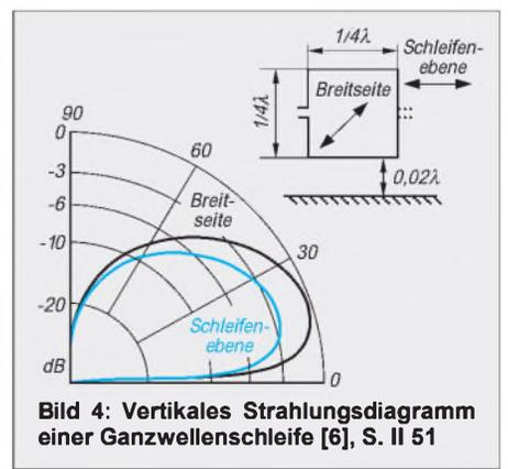
Bild 4: Vertikales Strahlungsdiagramm einer Ganzwellenschleife [6], S. II 51
