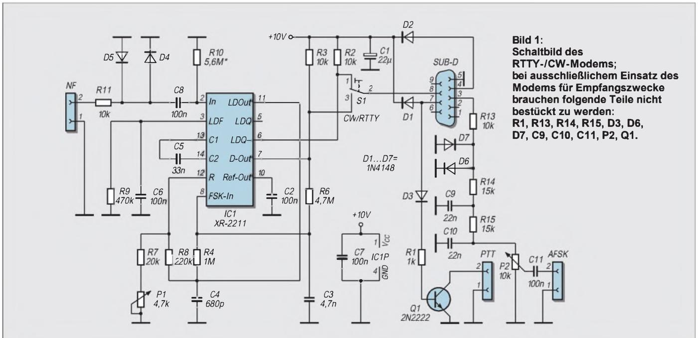
**Bild 1:** Schaltbild des RTTY-/CW-Modems; bei ausschließlichem Einsatz des Modems für Empfangszwecke brauchen folgende Teile nicht bestückt zu werden: R1, R13, R14, R15, D3, D6, D7, C9, C10, C11, P2, Q1.
