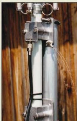
Die Titanex-Groundplane wiegt bei nur 5 m Länge ganze 5 kg, kommt ohne Abspannung aus und kostet 875 DM. Zwei Full-Size-Radials pro Band sind dabei.
