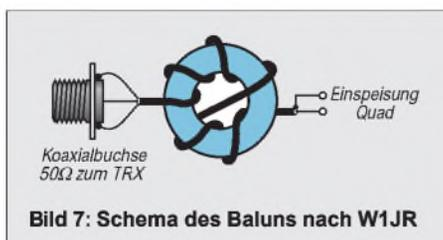
**Bild 7: Schema des Baluns nach W1JR**
