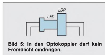
**Bild 5: In den Optokoppler darf kein Fremdlicht eindringen.**
