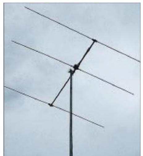
**Bild 11: Die 3-Element-Yagi im Testbetrieb**
