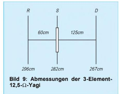
**Bild 9: Abmessungen der 3-Element-12,5- $\Omega$ -Yagi**
