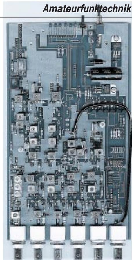
Bild 2: Ansicht einer mit allen Bandmodulen bestückten Konverterplatine
