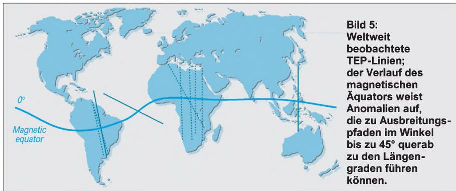
**Bild 5: Weltweit beobachtete TEP-Linien; der Verlauf des magnetischen Äquators weist Anomalien auf, die zu Ausbreitungspfaden im Winkel bis zu 45° querab zu den Längengraden führen können.**
