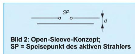
**Bild 2: Open-Sleeve-Konzept; SP = Speisepunkt des aktiven Strahlers**
