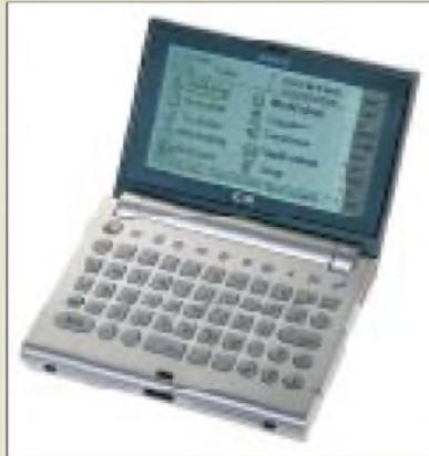
Das Gerät ist seit Februar 2000 zum Preis von 260 € auf dem Markt. In Verbindung mit einem Handy mit eingebauter Datenschnittstelle kann der IC35 sowohl für E-Mail als auch SMS (Short-Messaging-Services)-Anwendungen genutzt werden. Die Verbindung zum Handy wird über Infrarot-Schnittstelle oder über Kabel hergestellt.
