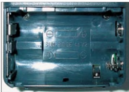
In das Batteriefach kommt ggf. auch der optionale Akku, er wird intern über die kleine Kontaktfahne geladen.
