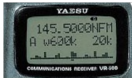
Mit der Spektrumdarstellung läßt sich die Aktivität in einem bis zu 6 MHz breiten Bereich auf einen Blick erfassen
