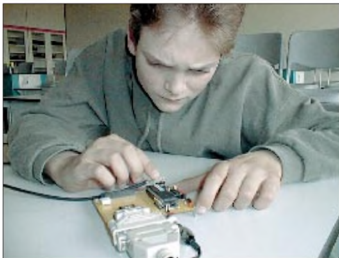
Bei den Seminaren zum Telematik-/WxNET-Projekt soll die mikrocontrollergesteuerte Wetterstation AS53-03 des AATiS aufgebaut werden. Christoph Rave, Schüler der KGS Neustadt am Rbge, schließt eine Sonde an die Wetterstation an. Foto: DK2SM
