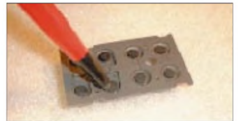
Bild 3: Vor dem Auftragen der Lösung werden die Gummiflächen mit einem Glasfaserpinzel angeraut.
