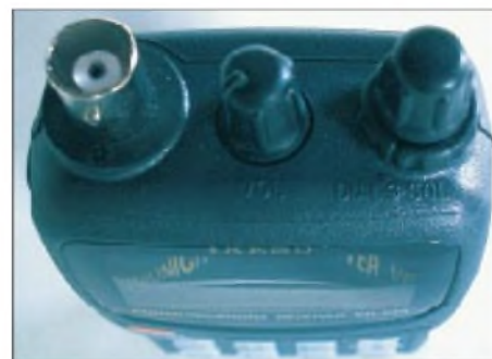
Gern gesehen: Antennenanschluß in BNC-Norm. Der Squelchdrehsteller liegt radial um den Hauptabstimmknopf.
