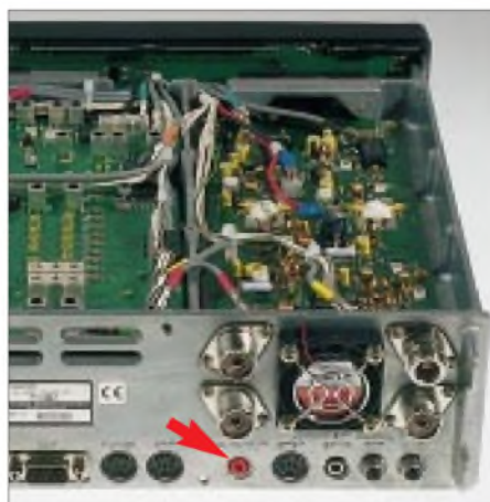
Bild 12: Moderne Transceiver, hier FT-847, verfügen über eine separate DATA-Buchse (5. v.r.) für externen NF-Zugriff.
