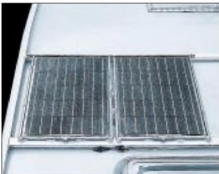
**Bild 1: Flache, hochgesetzte Montage auf dem Wohnmobildach**
