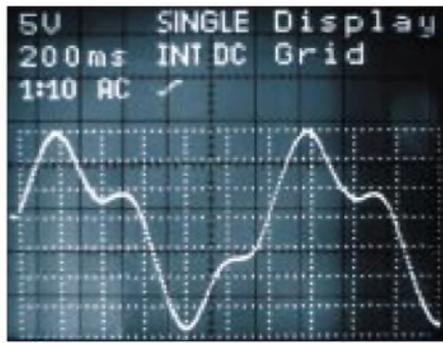
**Bild 3: Typisches Detektorsignal beim Wechsel der Chiptemperatur**
