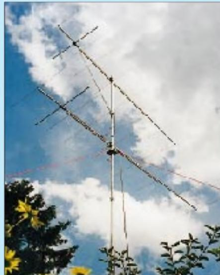
**Vertikale Stockung bringt knapp 3 dB mehr Gewinn und verringert den vertikalen (Freiraum-)Öffnungswinkel; die wirksame Höhe liegt in der Mitte beider Antennen. Fotos: rd**
