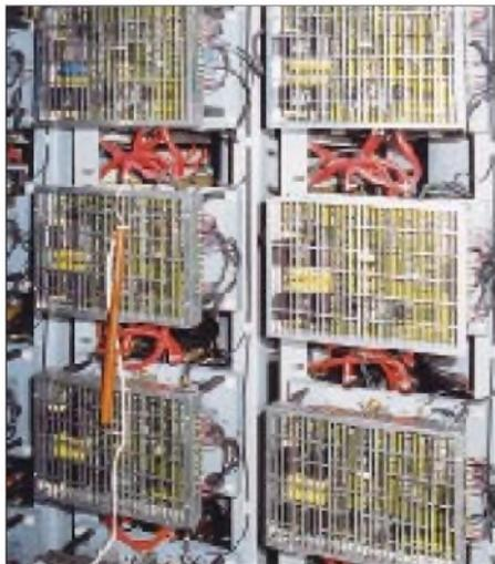
Die Modulationsstufe (Teilansicht) besteht aus 32 Halbleiter-Verstärkern.
