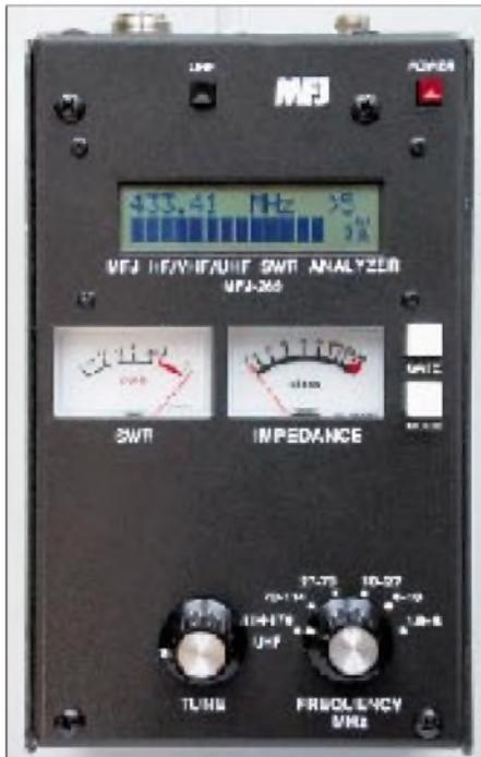
Äußerlich vom MFJ-259B kaum zu unterscheiden, erschließt der Neue noch das 70-cm-Band und wartet im KW-/2-m-Bereich mit höherer Genauigkeit auf. Fotos: FA
