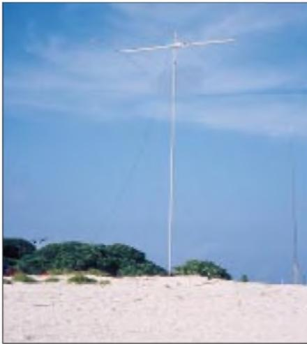
**Hohe Antennen kamen zum Einsatz, um ein starkes Signal in jeder Ecke der Welt sicherzustellen; fünf Richtantennen standen 9 m hoch. Der Vogelschutz wurde bei TX0DX mit drei alternativen Methoden getestet: hängende CDs zur Sonnenreflexion, bunte flatternde Bänder und schließlich das Einschmieren der Antennen mit glitschiger Vaseline. Muß eine schwierige Woche für die Vögel gewesen sein.**
