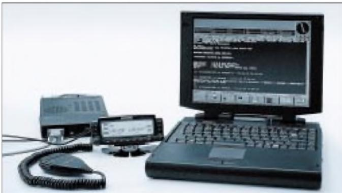
Der angeschlossene PC komplettiert den TM-D700E zur leistungsfähigen Datenstation, mit der Datenübertragung und FM-Sprechfunk gleichzeitig möglich sind.
