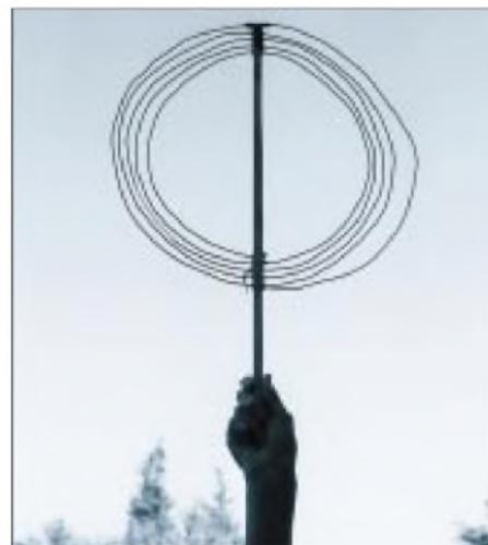
**Bild 3:** Schirmung einer Rahmenantenne mit Draht (außen, oben nicht verbunden)
