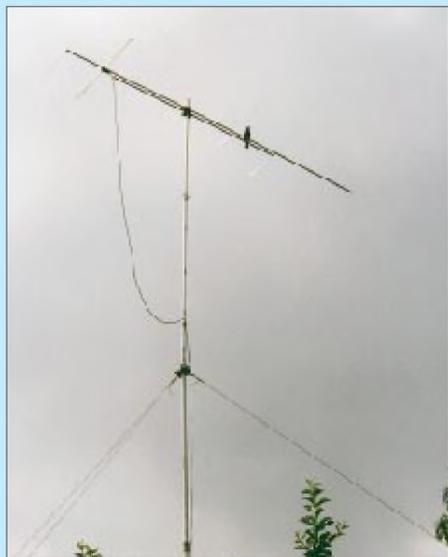
**Weniger ist mehr: Die leichtere Antenne gestattet eine Verlängerung des Mastes; das bringt gut 4 m mehr an wirksamer Höhe über Grund – der vertikale Abstrahlwinkel sinkt!**
