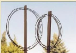
Magnetantennen werden vorzugsweise als Loops, Rahmen oder Ferritstabantennen ausgeführt. Unser Beitrag bietet eine Übersicht. Foto: DL7VFS
