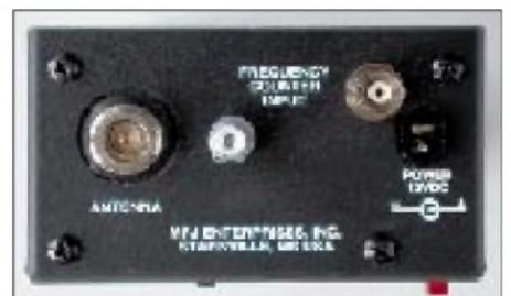
Die Draufsicht zeigt Antennen-, Zähler- und Stromversorgungsbuchse sowie die Erdungsklemme.
