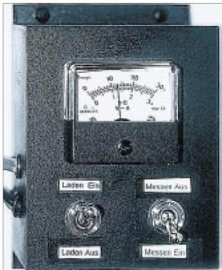
**Bild 3: Ladebox mit Schaltern und Amperemeter**
