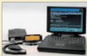
Eingebauter TNC, APRS-taugliche Firmware und PacSat-Fähigkeit macht aus dem TM-D700E ein Funkgerät, das dem experimentellen Aspekt des Amateurfunks neue Impulse gibt.
