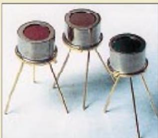
Pyrodetektoren findet man in Bewegungsmeldern oder Alarmanlagen. Sie signalisieren Temperaturänderungen, aber auch kleinste Luftdruckschwankungen. Foto: Fa. Heimann, Wiesbaden
