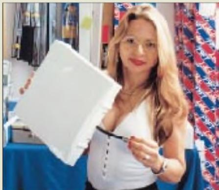
**Unscheinbar, aber leistungsfähig: Tonnas 30 x 30 cm<sup>2</sup> große Flachantenne für das 70-cm-Band, hier präsentiert bei Difona, weist 8dBi Gewinn auf.**
