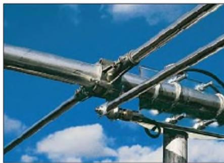
**Bild 2: Foto der Gamma-Anpassung (Originalzustand für 10 und 11 m)**
