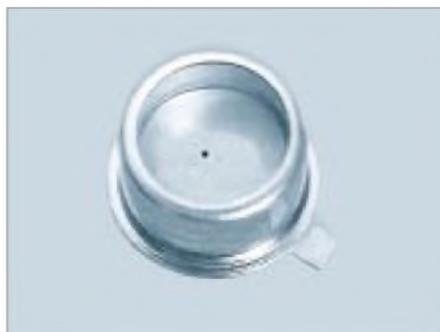
**Bild 2:** Der schwarze Punkt in der Mitte ist der SiC-Chip.
