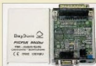
Mit PC, Funkgerät und einem kleinen Modem wie diesem ist schnell ein Zugang zum Amateur-Datennetz hergestellt. Werkfoto
