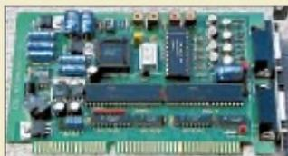
Auf diese Zusatzkarte für den PC mit einem DDS-Generator basiert das im Beitrag beschriebene Meßverfahren. Foto: H. Obernik
