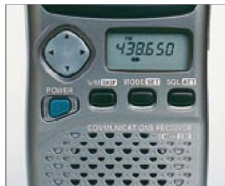
Wenige Tasten erschließen die gesamte Bedienungs Vielfalt des IC-R3. Ein kleines LC-Display gibt Auskunft über die wichtigsten Empfangsparameter.
