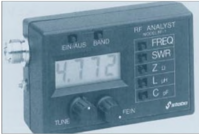
Bild 7: Der in die Hemdtasche passende RF-1 von Autec Research zeigt die Meßwerte digital an, wobei die jeweilige Meßgröße am Drehschalter auszuwählen ist.
